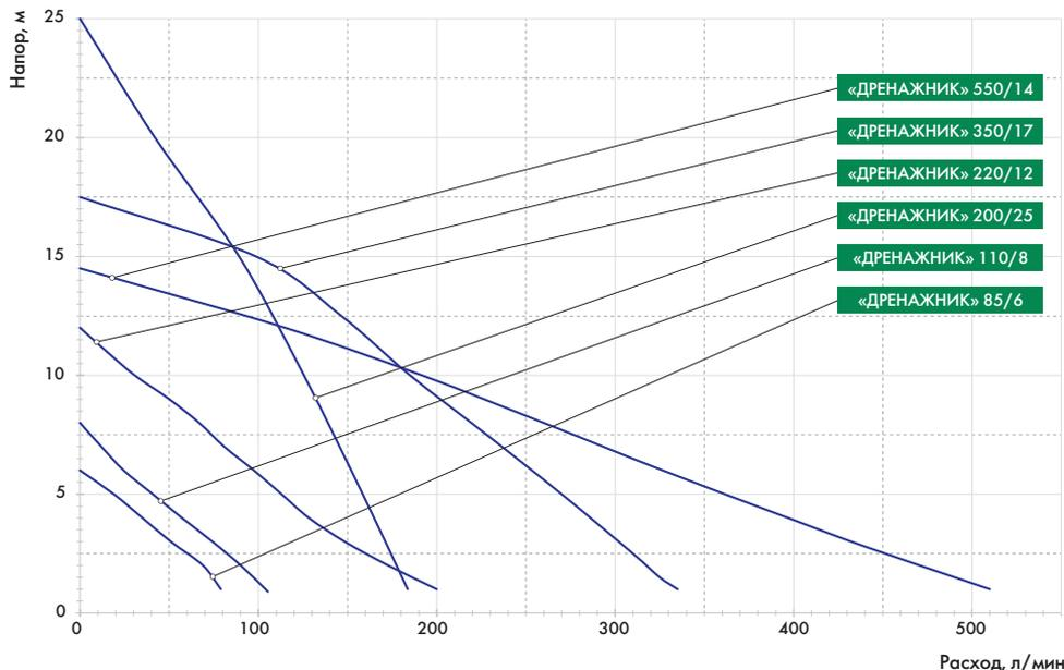
\* Заявленные характеристики насосов были получены при испытании с холодной чистой водой без газа и абразивных примесей, а также напорной магистралью диаметром 40 мм и напряжением электрической сети 220 вольт.
