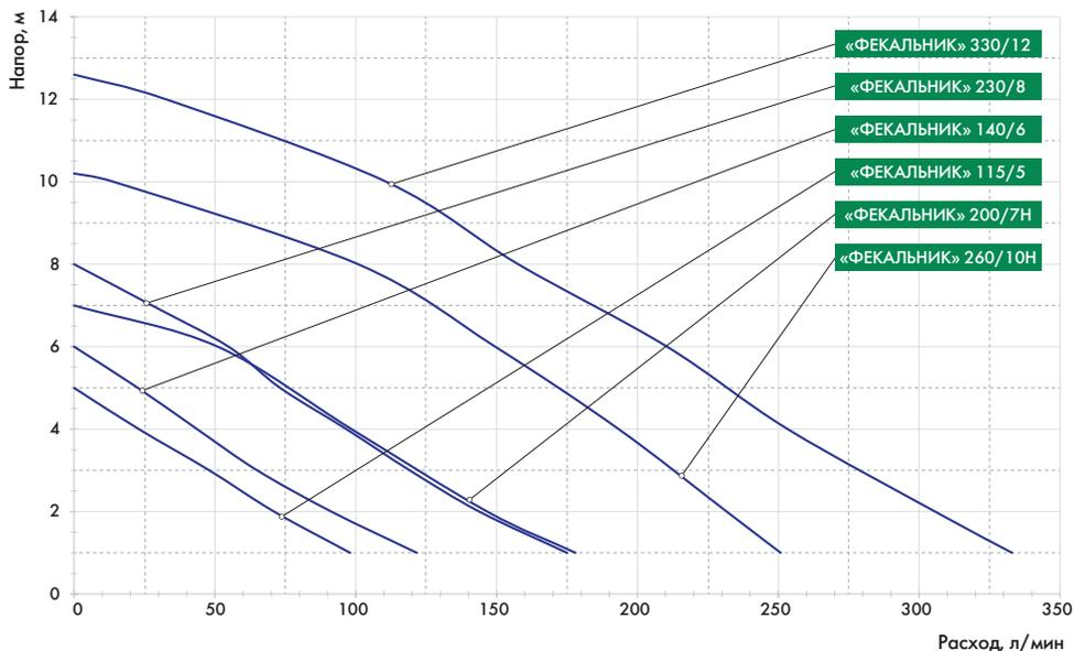
\* Заявленные характеристики насосов были получены при испытании с холодной чистой водой без газа и абразивных примесей, а также напорной магистралью диаметром 40 мм и напряжением электрической сети 220 вольт.
