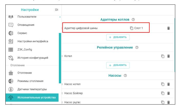
В настроечных параметрах Адаптера цифровой шины нужно проверить и при необходимости указать тип цифровой шины Modbus RTU и модель подключенного котла:
