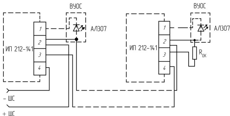
Схема подключения извещателей к двухпроводным шлейфам со знакопеременным напряжением.
