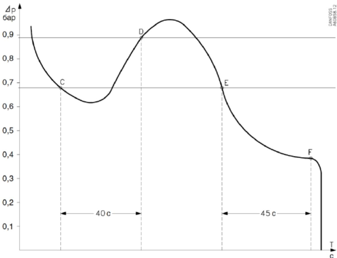
*Точка С.* Давление масла в процессе работы установки упало до заданного значения перепада давления. В точке С контакты 1-3 замыкаются и включается таймер.
