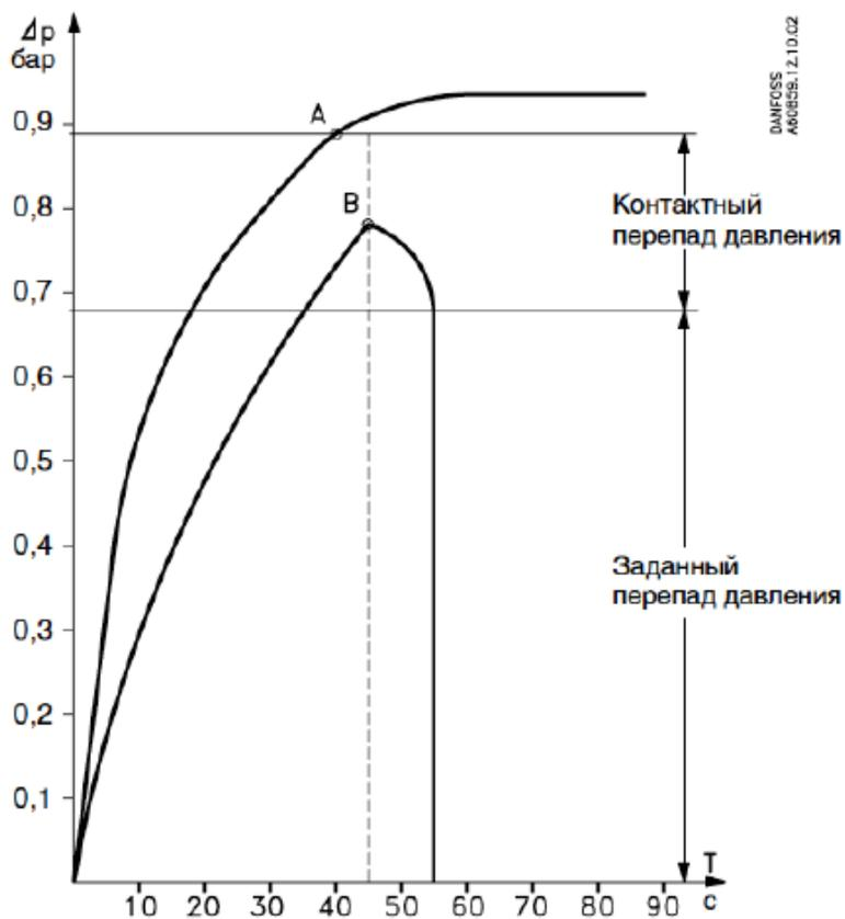
*Точка А: Нормальный пуск.* При включении компрессора давление масла возросло до заданной настройки давления плюс контактный перепад давления до того, как должен сработать таймер (в данном примере 45 с). В точке А контакты 1-5 размыкаются и таймер отключается, т.е. обеспечивается нормальная смазка компрессора.
