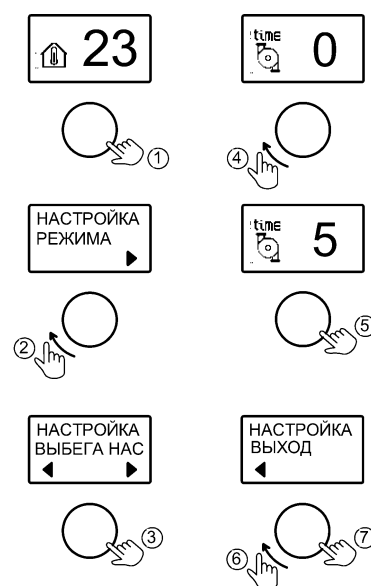
Рисунок 13. Настройка времени выбега насоса
