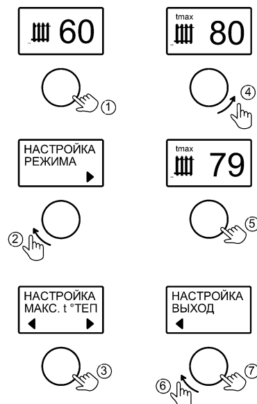
Рисунок 11. Настройка максимальной температуры теплоносителя
