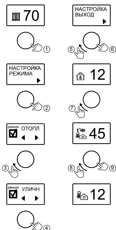
Рисунок 7. Выбор и настройка температуры
