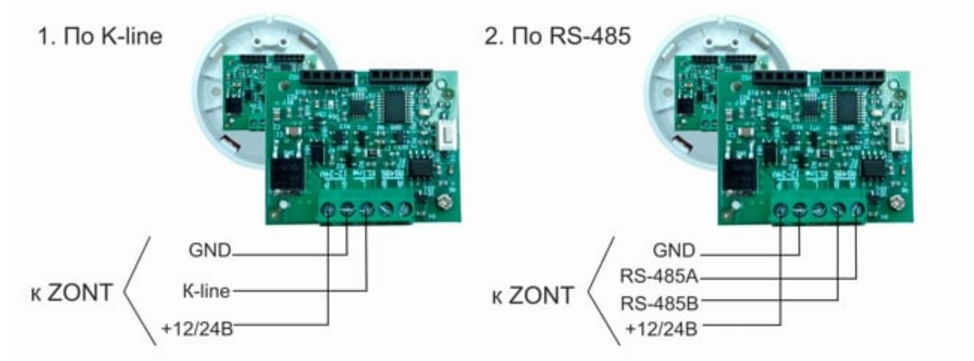
Максимальная длина линии **RS-485** не более 200 м. При больших длинах рекомендуется устанавливать дополнительные резисторы 120 Ом между клеммами А и В с обоих концов линии и использовать кабель UTP (витую пару) CAT5.
