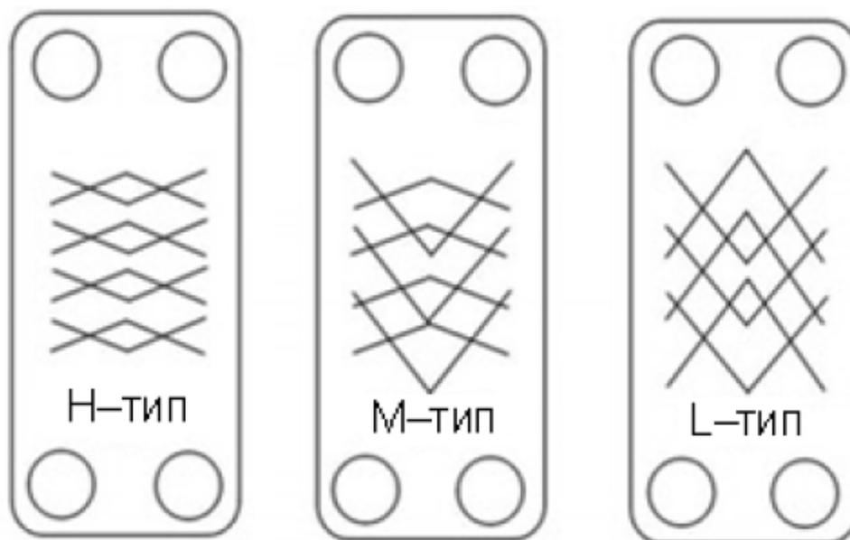
Рис.2 - Изображение каналов типов Н, L, М
