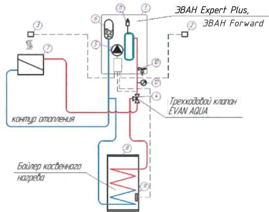
Упрощенная схема подключения электроотопительного котла ЭВАН Expert Plus, ЭВАН Forward с гидроразделителем, контуром ГВС, отопления и теплого пола (вариант 1)
