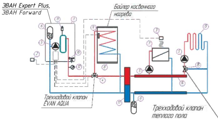
Упрощенная схема подключения электроотопительного котла ЭВАН Expert Plus, ЭВАН Forward с гидроразделителем, контуром ГВС, отопления и теплого пола (вариант 2)
