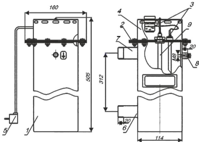
Устройство прибора ЭПО 2,5
