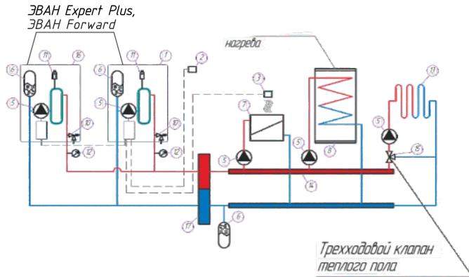
Упрощенная схема подключения электроотопительного котла ЭПО 4 – 240
