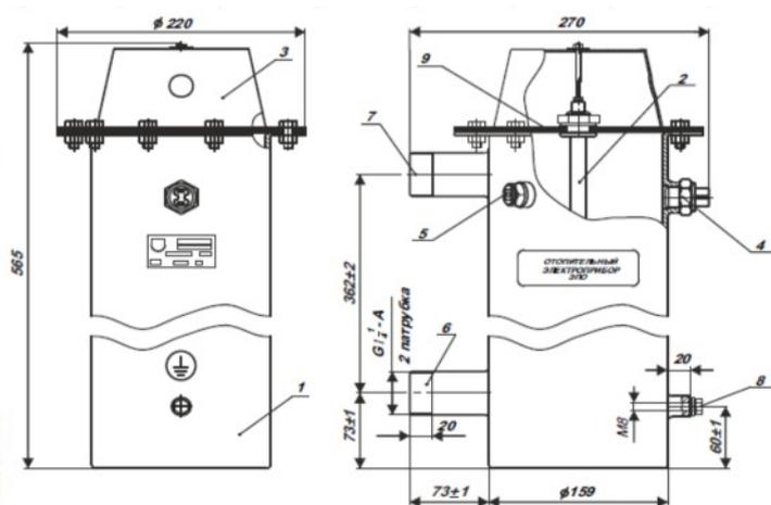
Устройство прибора ЭПО 4-30
