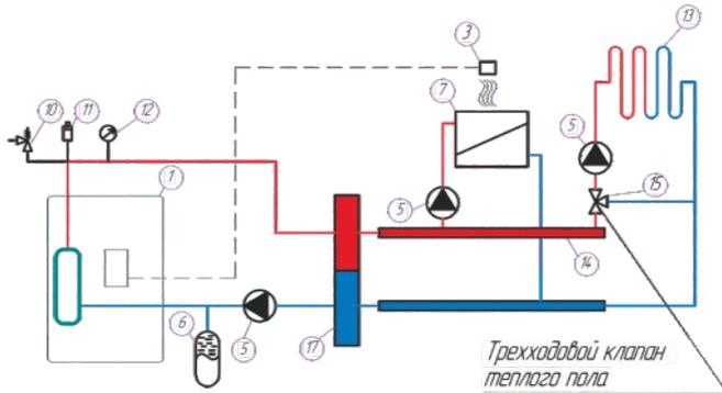
Упрощенная схема подключения электроотопительного котла с теплонакопителем, контуром отопления, ГВС и теплого пола
