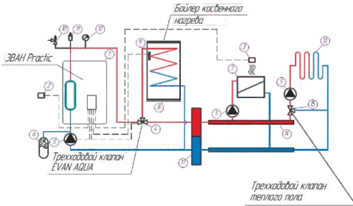
Упрощенная схема подключения электроотопительного котла ЭВАН Practic с гидроразделителем, контуром ГВС, отопления и теплого пола (вариант 2)
