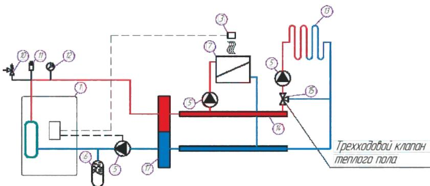
Упрощенная схема подключения электроотопительного котла ЭВАН Pratic с контуром ГВС
