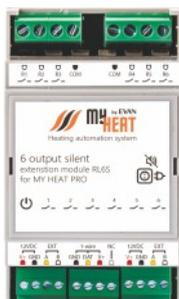
Блок расширения MyHeat RL6S предназначен для бесшумной коммутации дополнительных шести выходов электрической нагрузки посредством симистора. Блок расширения подключается к контроллеру MyHeat PRO по проводной шине. Блок расширения MyHeat RL6S оснащен встроенной функцией ПИД-регулирования до 3-х контуров одновременно. MyHeat RL6S расширяет возможности контроллера благодаря 6-ти дополнительным симисторным выходам.
