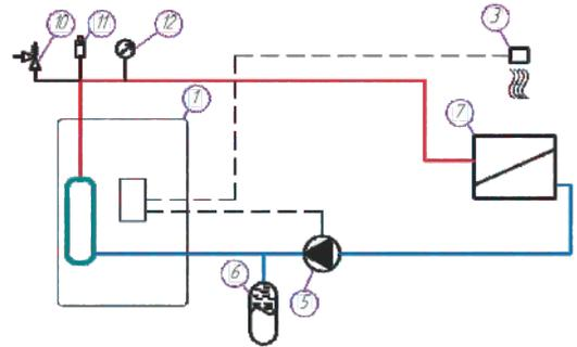
Упрощенная схема подключения электроотопительного котла ЭВАН Next, ЭВАН Next Plus с гидроразделителем, контуром отопления и теплого пола
