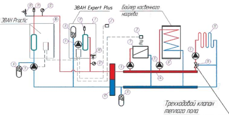
Упрощенная схема подключения электроотопительного котла ЭВАН Expert Plus, ЭВАН Forward с контуром ГВС
