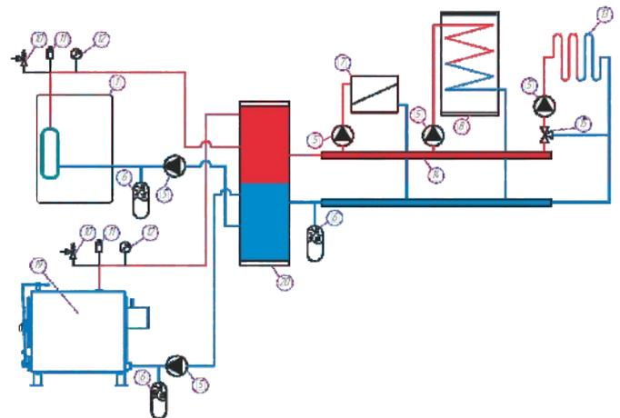
Упрощенная схема подключения электроотопительного котла ЭПО 300 – 480 с гидроразделителем
