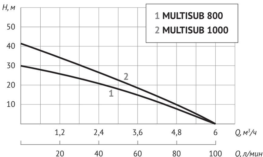
**Примечание:** приведённые данные по максимальному напору и максимальной производительности справедливы при напряжении электросети 220/230 В, минимальном сопротивлении потоку воды при всасывании и движении в напорной магистрали.
