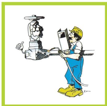
Производите сварку только в открытом положении запорной арматуры
