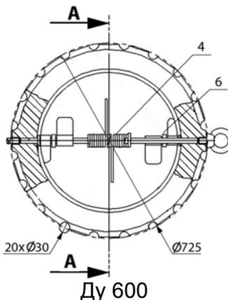
При монтаже в горизонтальном положении, ось клапана должна быть в вертикальном положении.
