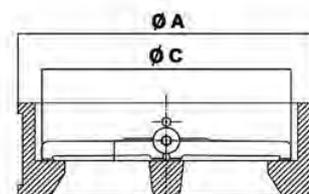
При монтаже в горизонтальном положении, ось клапана должна быть в вертикальном положении.
