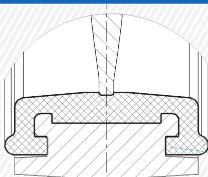
Выступы на внешней стороне манжеты обеспечивают лучшую герметичность при установке между фланцами
