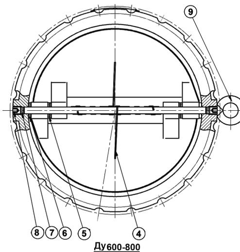
При монтаже в горизонтальном положении, ось клапана должна быть в вертикальном положении.
