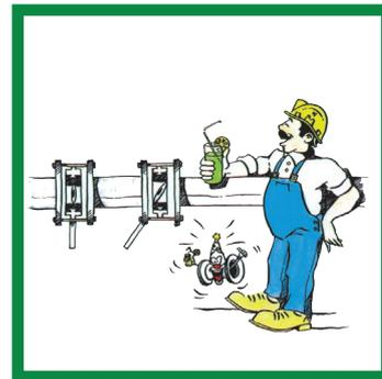
При монтаже оставьте диск затвора полуоткрытым
