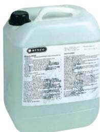
Пластификатор HENCO для бетона (мин. толщина бетона над трубой 45 мм), добавляется 1% от массы сухого цемента
