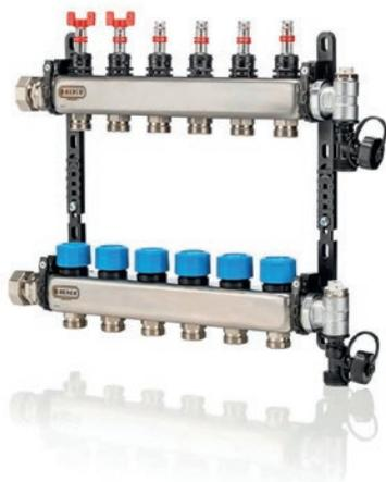
Коллектор HENCO из нержавеющей стали с регулируемыми расходомерами, термометрами (накладными), клапаном слива и воздухоотводчиками, присоединение 1"BP накидная гайка.
