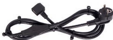
Ограничительный термостат со шнуром и вилкой. Кабель питания 3-х жильный на 230 В со встроенным накладным термостатом. Применяется в насосно-смесительных узлах для предотвращения превышения температуры теплоносителя выше 55 °С
