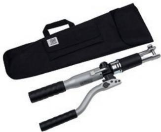
HENCO Гидравлическая ручная пресс-машина + сумка. Пресс-инструмент позволяет обжимать фитинги HENCO 14-32 диаметра. Гидравлическая система облегчает монтаж и требуемое усилие для обжима гильзы фитинга. Совместима с насадками BE-H
