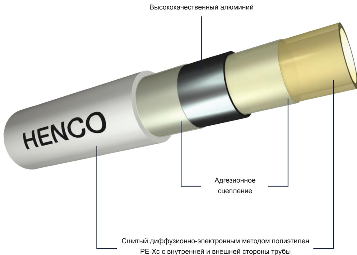
Трубы Henco — это сшитый полиэтилен с внутренней и внешней стороны трубы, усиленный высококачественным алюминием, который не пропускает кислород и защищает компоненты систем отопления от коррозии и разрушения. Инновационная диффузионная сшивка электронным методом позволяет трубе быть стерильной, то есть универсальной, использоваться как для водопровода с чистой питьевой водой, так для любых других нужд. Этот метод сшивки является на сегодняшний день самым безопасным и надежным в эксплуатации.
