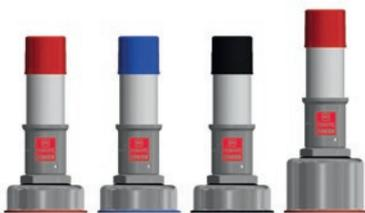
Спринклерное соединение HENCO в сборе: стакан (23 мм или 43 мм) из нержавеющей стали ВР, предустановленная труба 32 мм (L=100 мм), заглушки на трубе и стакане
