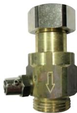
Термостатический ограничитель температуры HENCO с ручным воздухоотводчиком для коллекторов напольного отопления. Отключает подачу теплоносителя в петле при его температуре ниже 18 °С для предотвращения выпадения конденсата.
