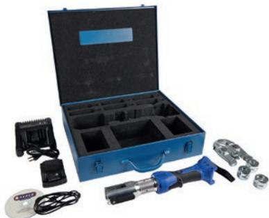
Электрическая пресс-машина HENCO M-BMINI3 с контролем обжатия, зарядным устройством, аккумулятором 18В/1,5Ah Li-ion, металлическим кейсом, с набором из универсальных пресс-клещей HENCO BE-MINI3 и сменных пресс-вставок HENCO BE-H для Ø16, 20, 26. Усилие обжатия 19 кН.
