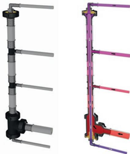
HENCO Ecoline или система «труба в трубе» — это энергосберегающее решение для контура циркуляции ГВС, которое экономит энергию за счет снижения теплового потока.
