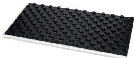
Профильный мат HENCO с 24 мм EPS изоляцией. Размер 1200 x 600 x 45 мм. Максимальная нагрузка 5 кПа (500 кг/м<sup>2</sup>).
