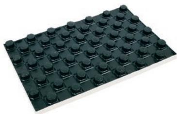
Профильный мат HENCO с 30 мм EPS изоляцией, с улучшенной шумоизоляцией (28 дБ). Размер 1400 x 800 x 52 мм. Максимальная нагрузка 5 кПа (500 кг/м<sup>2</sup>).
