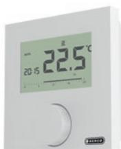
Термостат цифровой HENCO CU-REGK, с ЖК-дисплеем, накладной, диапазон температур +5°C...30°C, переключение режимов Отопление/Охлаждение, функция защиты системы от замерзания, функция защиты клапана от закисания, без возможности подключения датчика температуры пола, до 5 термоприводов на версии 24 В и 230 В
