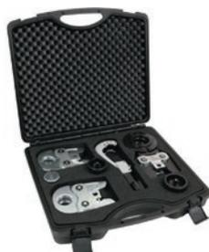
Набор HENCO: насадки калибровочные KS-M40, KS50, KS63, пресс-клещи BE40, BE50, BE63, круговой резак RS63. Подходит для пресс-машин HENCO M-BHY и M-BA03, а также для других пресс-машин с усилием обжатия 32 кН\*
