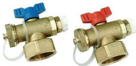
Комплект концевых элементов HENCO для латунного коллектора MD с накидной гайкой 1"BP, с шаровым краном, дренажным краном и воздухоотводчиком 3/8"
