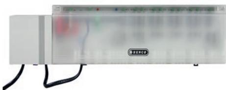
Базовый модуль HENCO CU-6ZONEP на 6 зон (6 термостатов), до 15 термоприводов, переключение режимов Отопление/ Охлаждение, реле насоса (Вкл./Выкл.), без LED-индикаторов состояния термостатов, без реле котла, в комплекте электрический трансформатор для моделей на 24В
