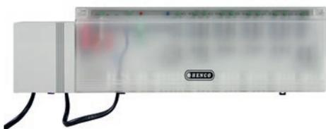
Базовый модуль HENCO CU-10ZONEK на 10 зон (10 термостатов), до 21 термопривода, переключение режимов Отопление/ Охлаждение, реле насоса (Вкл./Выкл.), реле котла (Вкл./Выкл.), LED-индикаторы состояния термостатов, в комплекте электрический трансформатор для моделей на 24В
