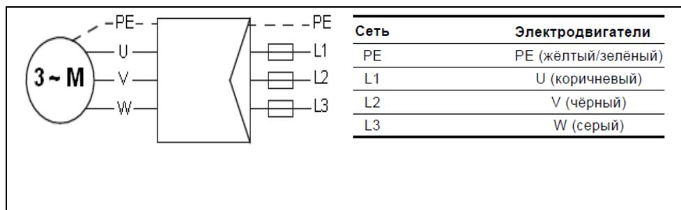
Для подключения используйте водостойкий кабель с поперечным сечением каждой жилы не менее 1,5 мм<sup>2</sup> и с резиновой изоляцией, предназначенный для эксплуатации в питьевой воде (подробнее по длине кабеля (см Таб.3).
