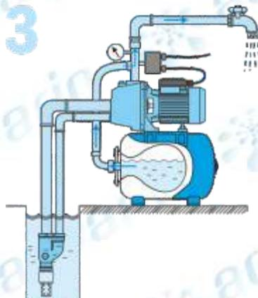
**Рис.9** При возобновлении водоразбора, вода, находящаяся в гидроаккумуляторе под давлением, начинает поступать потребителю. Давление в системе при этом постепенно снижается, а насос остается выключенным.
