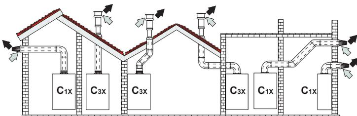
Рис. 8. Примеры присоединения с помощью коаксиальных труб
