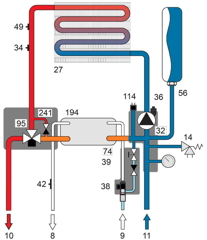
Рис. 18. Отопительный контур
