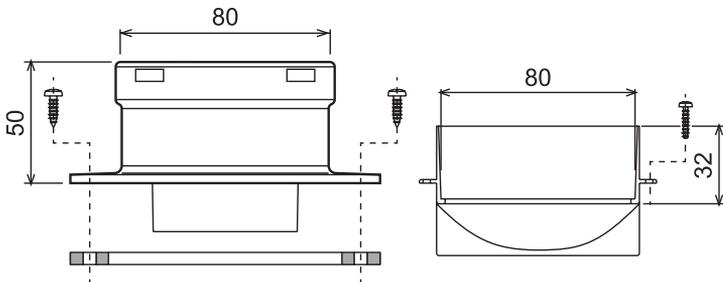
Рис. 11. Соединительный элемент для раздельного дымоудаления (арт. 01000)
