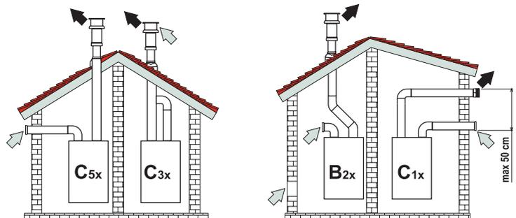
Рис 10. Примеры присоединения с помощью отдельных труб
