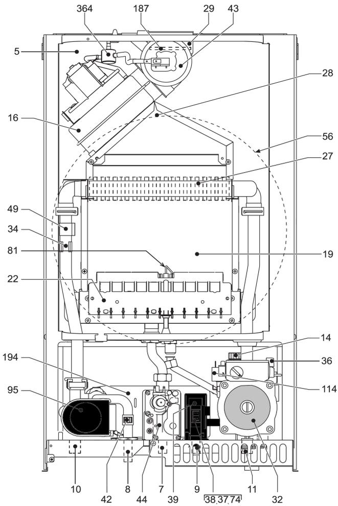
Рис. 176. Конструкция Vitatch D F32-40
