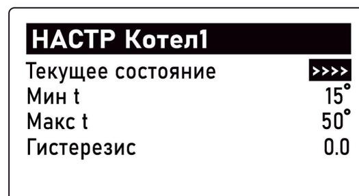
Для котлов необходимо указать границы температуры теплоносителя, взяв эти значения из сервисной настройки каждого котла. Если котел подключен к Регулятору по цифровой шине, то нужно указать тип цифровой шины (протокола) и модель котла.
