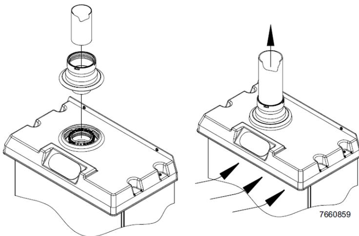
При установке дымохода тип В23 воздух горения направляется за пределы помещения, в котором установлен котел. Для отвода дымов необходим комплект дополнительного оборудования для монтажа трубопровода 80 мм и переходник для дымохода 60/80 мм.
