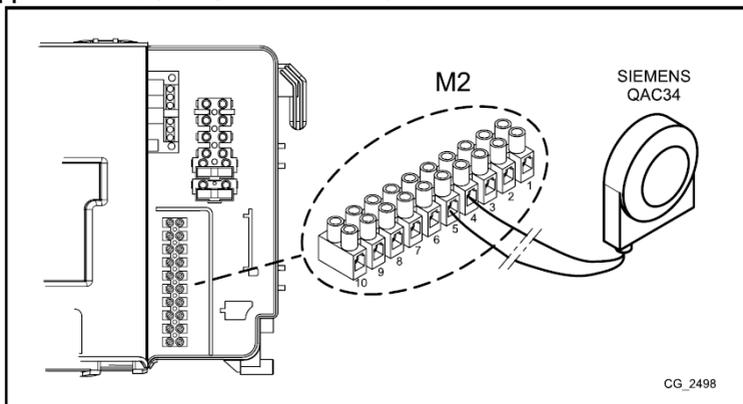
Подключите провода датчика наружной температуры к клеммам 4-5 клеммной колодки М2, как показано на рисунке выше, соблюдайте указания руководства, поставляемого в комплекте с датчиком.
