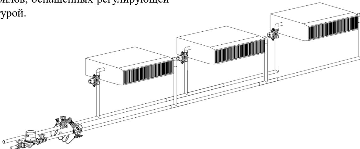
При изменении порядка установки комплектов с клапаном DPCV, как показано на рисунке ниже, их можно использовать для управления общим расходом.
