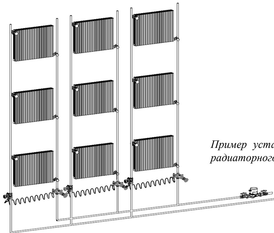
*Пример установки в системах радиаторного отопления*
