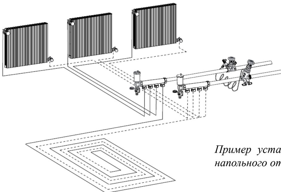
*Пример установки в системах напольного отопления*
