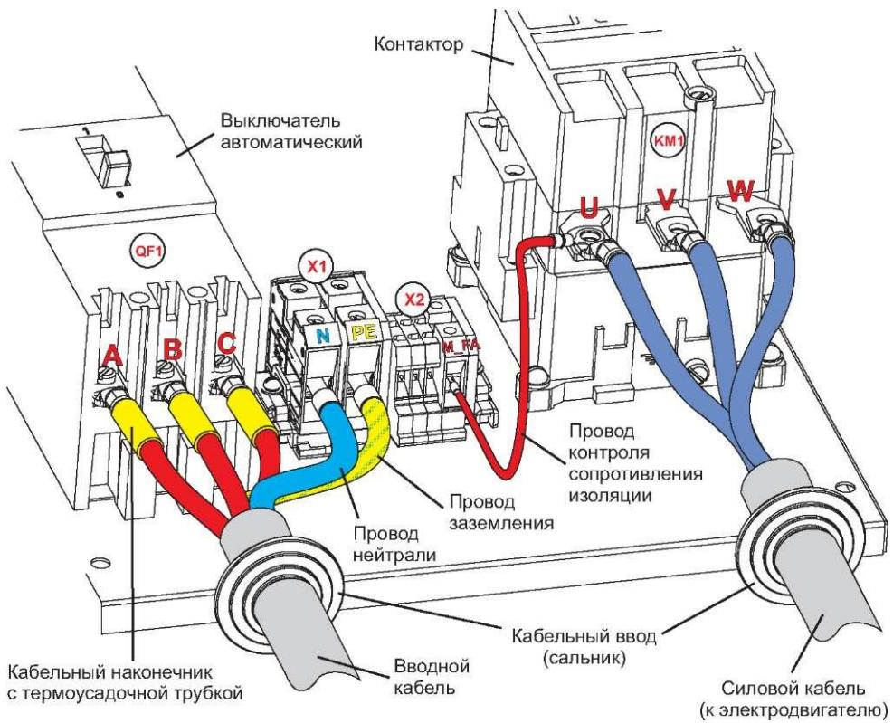
2.4.4 Проверить правильность подключения всех цепей согласно схемы электрической соединений (Приложение В).
