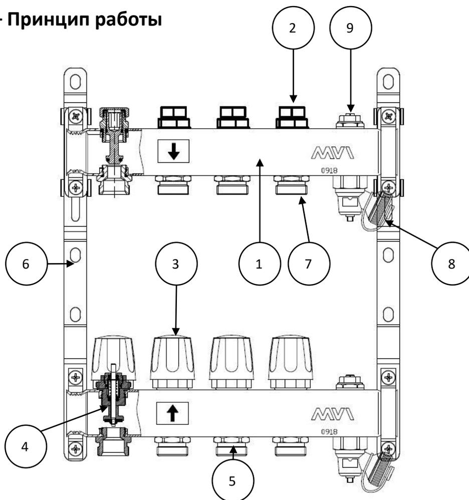
Транспортируемая среда поступает в подающий коллектор с запорными (настроечными) клапанами (1), который изготавливается из нержавеющей стали AISI304. Далее она распределяется по контурам проходя ответную часть клапана (7).
