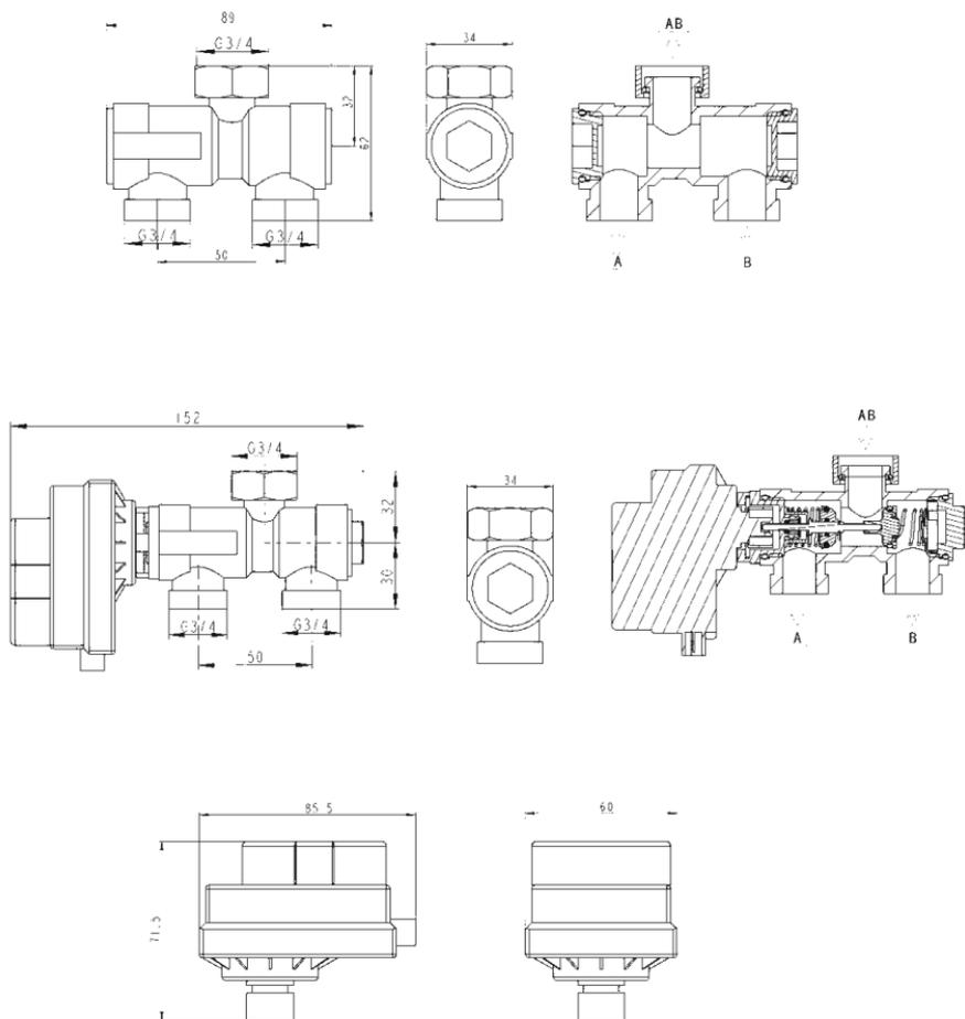
Рисунок 2. Габаритные размеры. Все размеры указаны в миллиметрах.
