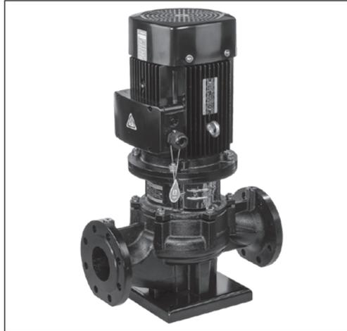
Насосы RV являются одноступенчатыми моноблочными насосами со всасывающим и напорным патрубками одинакового размера, расположенными на одной оси. Насосы оснащены асинхронными электродвигателями с воздушным охлаждением.
