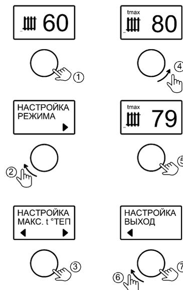
Рисунок 9. Настройка максимальной температуры теплоносителя
