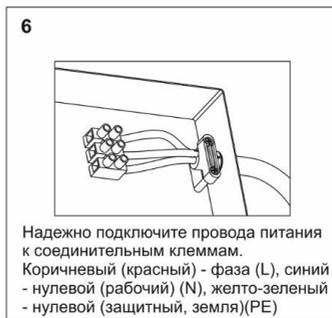
**Рис.4 Подключение кабеля питания**
