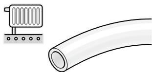
Произведённые из высококачественного сшитого полиэтилена PE-Xa, трубы Uronog Comfort Pipe Plus и Radi Pipe специально разработаны для систем отопления, охлаждения и
