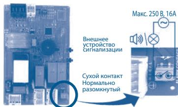
Сигнал тревоги можно передать на внешний подряд. Такие модели оснащены сухим (беспотенциальным) нормально разомкнутым контактом, которым можно управлять с помощью реле.
