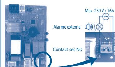
Possibilité d'externaliser le signal d'alarme. Contact sec (pas de voltage) NO (normalement ouvert) actionné par un relais.
