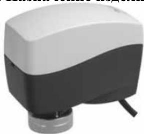
Приводы электрические типа AMV модификация 120 NL (далее – АМЕ 120 NL) предназначены для работы с клапанами балансировочными типа АВ-QM, управляющими подачей тепло- и холодоносителя в фэнкойлы или небольшие вентиляционные установки.
