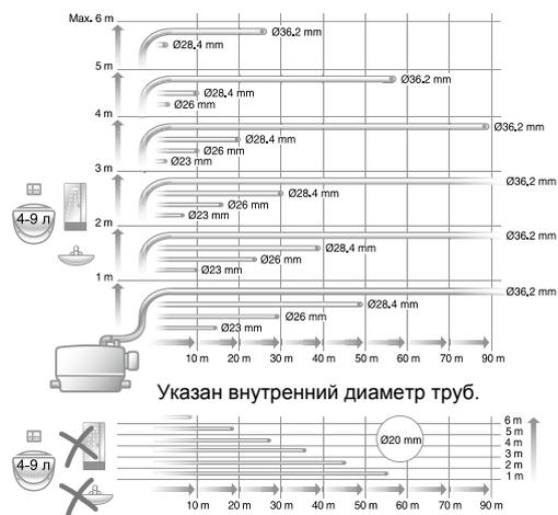
Рис. 58. Максимальная длина вертикальных и горизонтальных сливных труб
