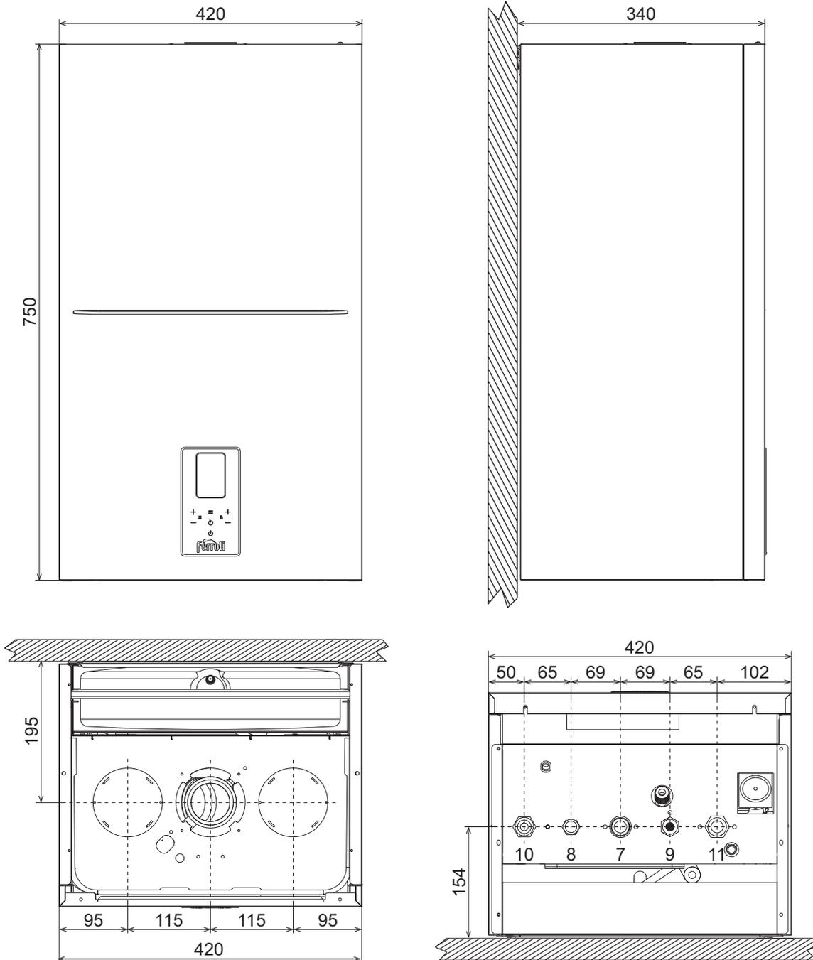
рис. 40- Размеры и соединения модели DIVATOP D F32
