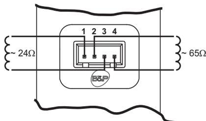
Рис. 30 - Электрический разъем для подключения газового клапана
