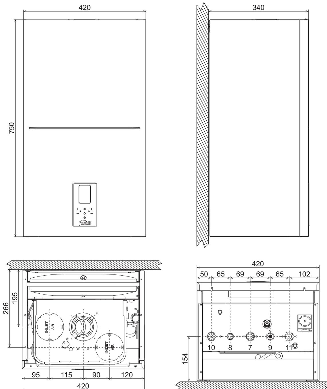
рис. 39- Размеры и соединения модели DIVATOP D F24
