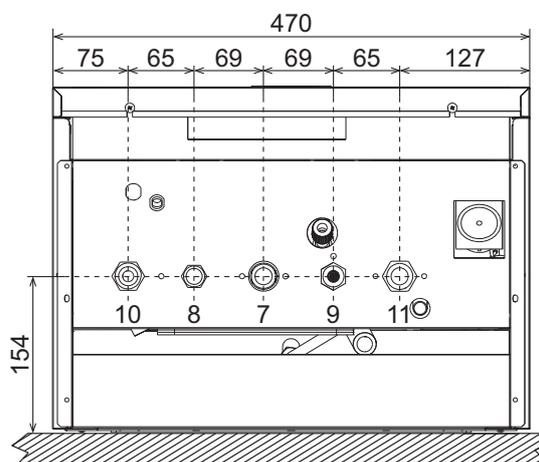
рис. 41- Размеры и соединения модели DIVATOP D F37
