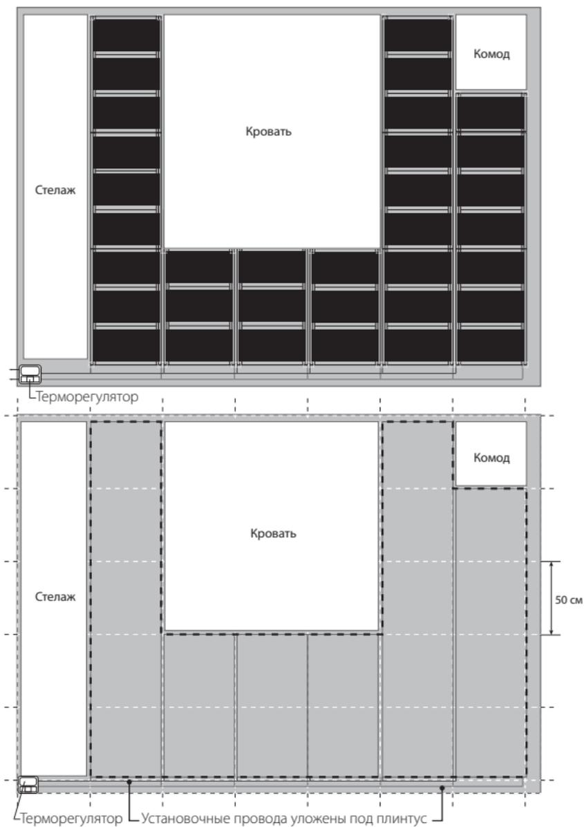
Рисунок 6. Пример плана размещения теплых полов.
