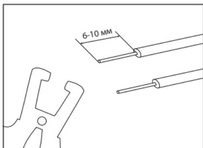
Рисунок 18. Зачистка концов установочных проводов от изоляции.
