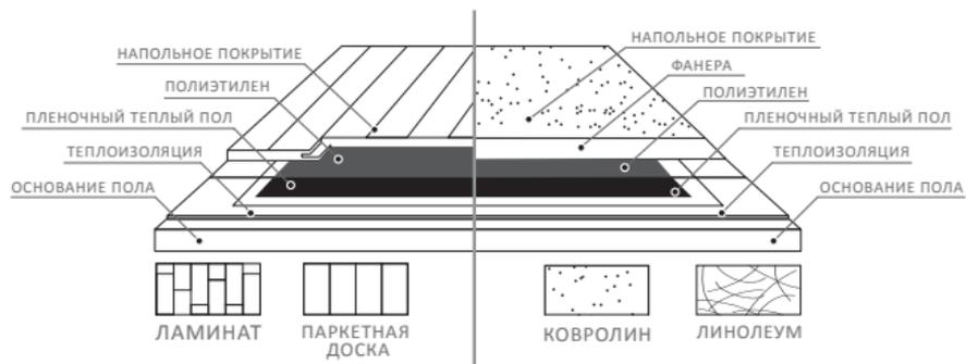
Рисунок 24. Схемы укладки твердых и мягких напольных покрытий.
