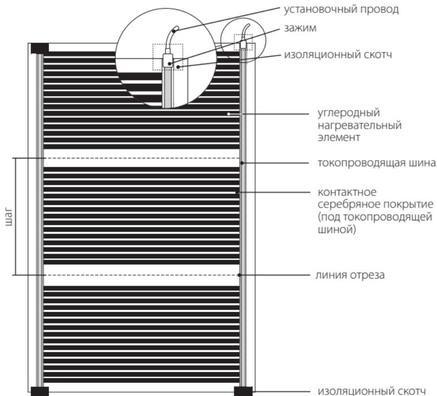
Рисунок 2. Конструкция нагревательной пленки (вид снизу)
