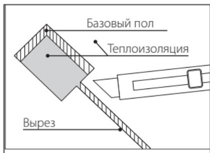
Рисунок 17. Подготовка теплоизоляции в месте размещения датчика температуры.
