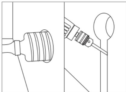
Рисунок 8. Подготовка отверстия под сервисную коробку терморегулятора.
