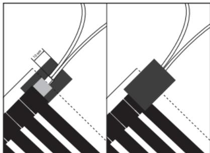
Рисунок 20. Правильная изоляция электрических соединений (зажимов).
