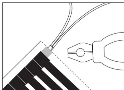
Рисунок 19. Подключение к нагревательной пленке установочных проводов.
