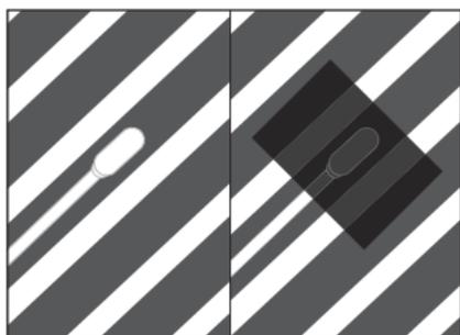
Рисунок 16. Установка датчика температуры на нагревательной пленке.
