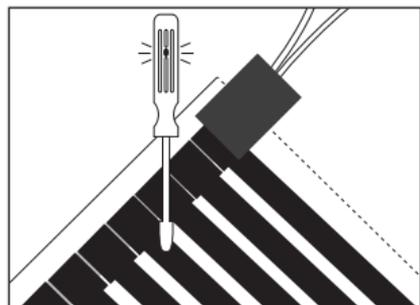
Рисунок 23. Проверка системы обогрева с помощью индикаторной отвертки.
