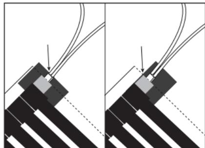
Рисунок 21. Примеры неправильной изоляции зажимов.
