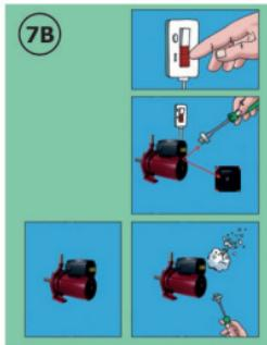
Подать напряжение и установить переключатель в положение «Max», выкрутить винт для удаления воздуха, защитив электрические части от попадания жидкости или пара. После того, как вода, выходящая из насоса, перестанет содержать воздух, винт завернуть.
