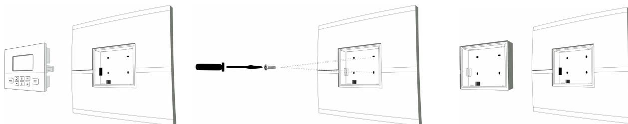
2. **Отожмите** защелки, расположенные по краям лицевой панели, и снимите переднюю панель основного блока Регулятора:
