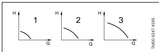
Частота вращения электродвигателя определяется положением переключателя, как показано в следующей таблице.
