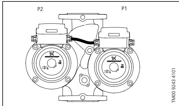
В сдвоенных насосах выход сигнала релейного модуля может использоваться не только для сигнализации, но и для регулирования режима работы насосов 1 и 2.
