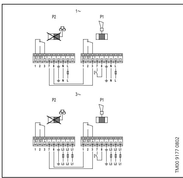
**Резервный режим:** насос 2 выполняет функции рабочего, а насос 1 – резервного насоса.
