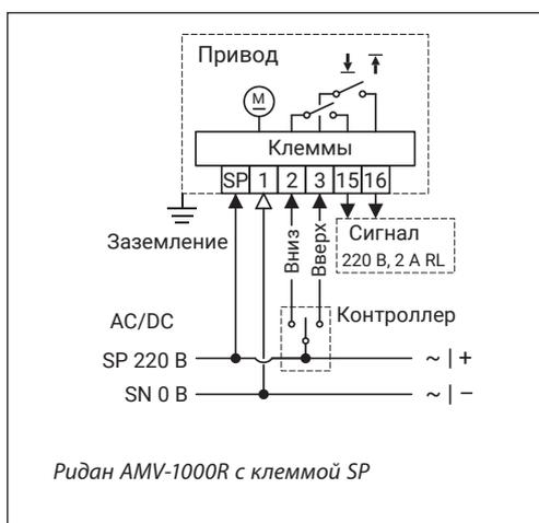
**Электрическая схема AMV-1000R 220В с клеммой SP**
