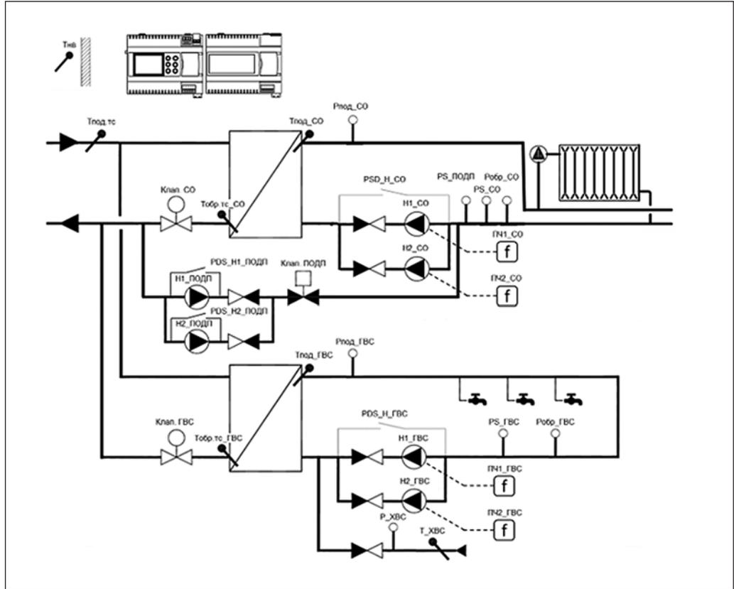
Электрические подключения датчиков и исполнительного оборудования ECL4 Control 368R ПЧ и ECL4 Control 368R ПЧ Ethernet
