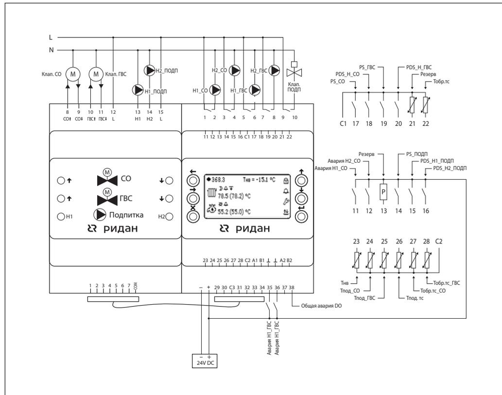
**Конфигурация входов/ выходов ECL-3R 368 и дополнительного модуля ECL-3R Triac** (для версии контроллера 1.18 конфигурация 3)
