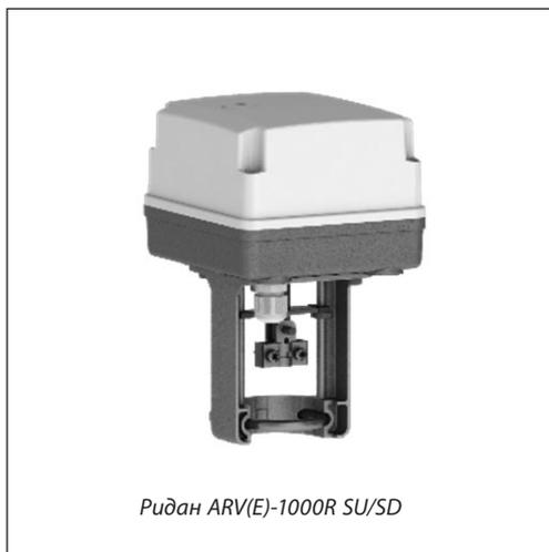
Электроприводы ARV(E)-1000R SU/SD предназначены для управления регулирующими клапанами импульсным или аналоговым сигналом от электронных регуляторов Ридан ECL-3R/4R или подобных в системах центрального тепло- и холодоснабжения, отопления, вентиляции и кондиционирования воздуха.
