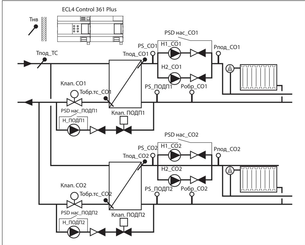
**Электрические подключения датчиков и исполнительного оборудования к ECL4 Control 361R Plus**
