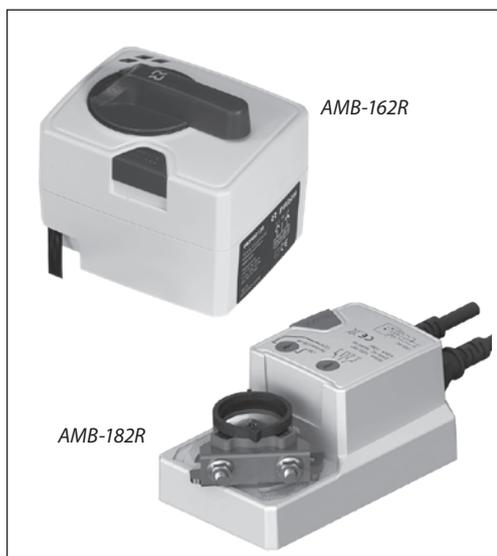
Привод электрический поворотный Ридан АМВ-162R 2-/3-позиционный предназначен для управления шаровыми кранами Ридан АМЗ-112R, АМЗ-113R, клапанами Ридан HRB-3R, HFE-3R DN20–100 и аналоговый привод для управления поворотными клапанами Ридан HRB-3R, HFE-3R DN20–100. АМВ-182R предназначен для HFE-3R DN125–150, при регулировании температуры в системах централизованного теплоснабжения.
