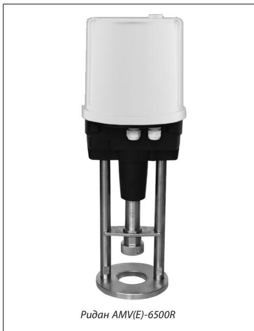
Электропривод предназначен для управления регулирующими клапанами VFM-2R DN250, VF-2R DN250 и VF-3R DN100–250. Управление приводом Ридан AMV-6500R осуществляется по импульсному сигналу от трехпозиционных электронных регуляторов Ридан ECL-3R/4R или подобных. Привод Ридан AME-6500R управляется аналоговым сигналом.
