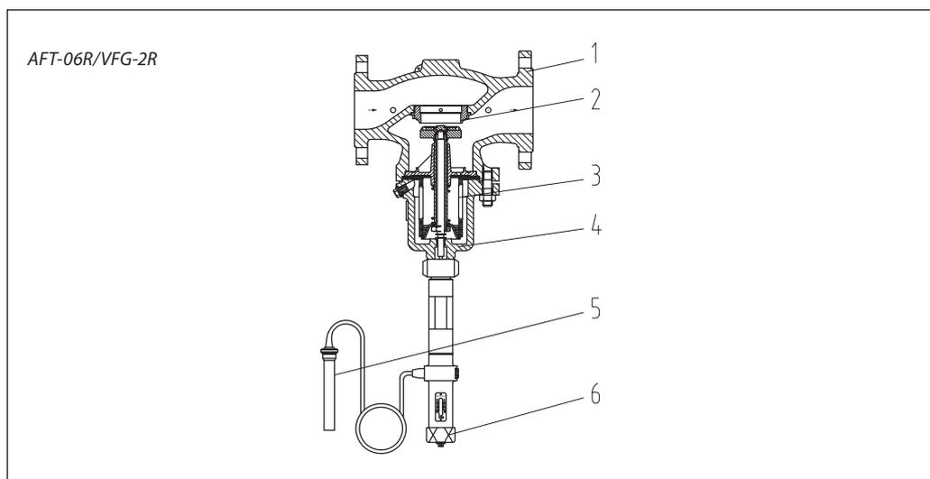
Изменение температуры рабочей среды внутри датчика изменяет ее объем и давление, которое передается по капиллярной трубке на пружину термоэлемента. Пружина, сжимаясь или растягиваясь, перемещает связанный с ней
