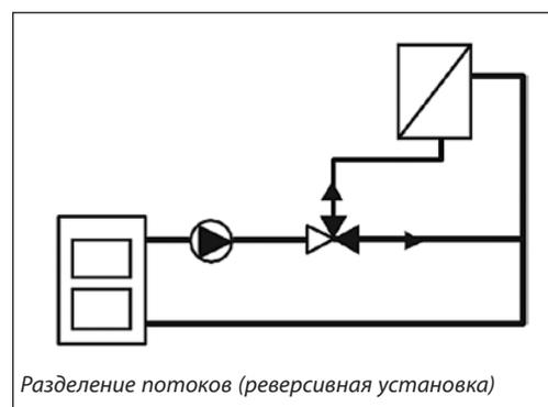
При необходимости реверсирования потоков требуется изменить направление вращения электропривода и положение шкалы индикатора
