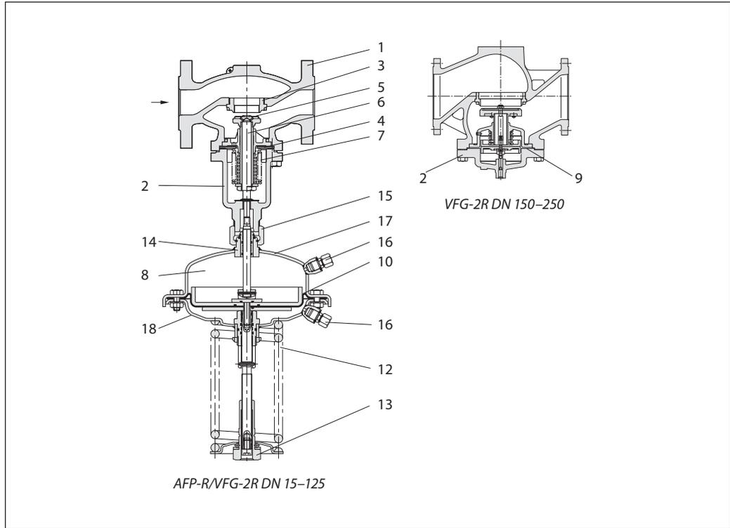
Рост давления в подающем и обратном трубопроводах будет передаваться через импульсные трубки в регулирующий блок. При возрастании перепада давления регулятор клапана
