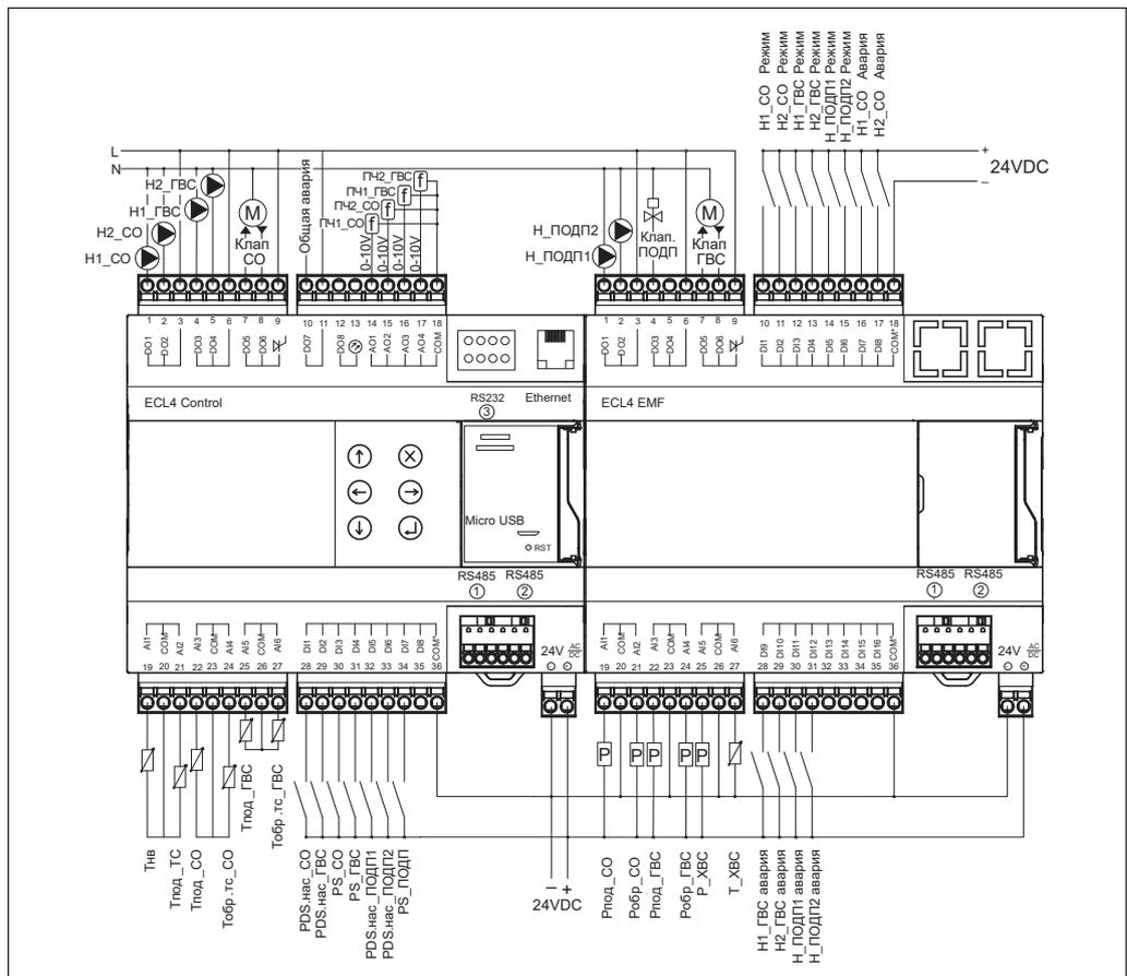
**Конфигурация входов и выходов контроллера ECL4 Control 368R ПЧ и ECL4 Control 368R ПЧ Ethernet**
