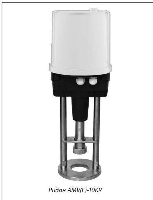
Электропривод предназначен для управления регулирующими клапанами VFM-2R DN300, VF-3R DN100–300 и VF-2R DN300. Управление приводом Ридан AMV-10KR осуществляется по импульсному сигналу от трехпозиционных электронных регуляторов Ридан ECL-3R/4R или подобных. Привод Ридан AME-10KR управляется аналоговым сигналом.
