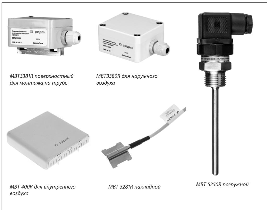
Термопреобразователи сопротивления платиновые MBT3380R, MBT3381R, MBT3281R, MBT400R, MBT5250R с чувствительным элементом Pt1000 применяются в зависимости от исполнения для измерения температуры окружающей среды, как снаружи, так и в помещениях, для измерения температуры теплоносителя при монтаже на поверхности трубы и при установке в трубопровод.
