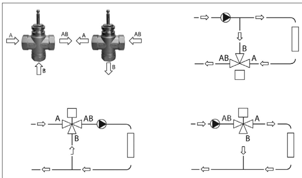
**Выбор типоразмера клапана**
