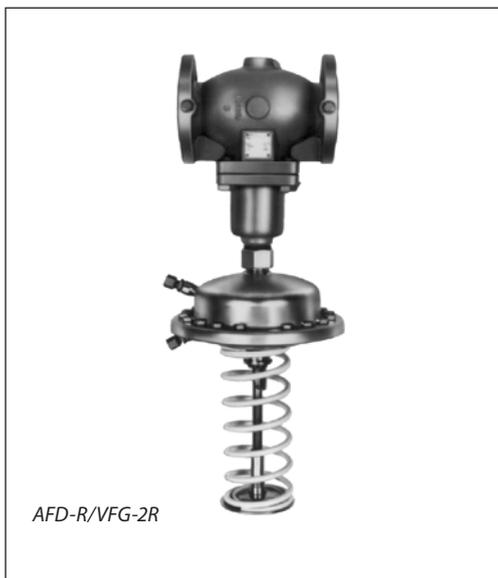
Регулятор Ридан AFD-R/VFG-2R является автоматическим редукционным клапаном для применения в системах централизованного теплоснабжения. При повышении давления после регулятора (по ходу движения теплоносителя) клапан закрывается.
