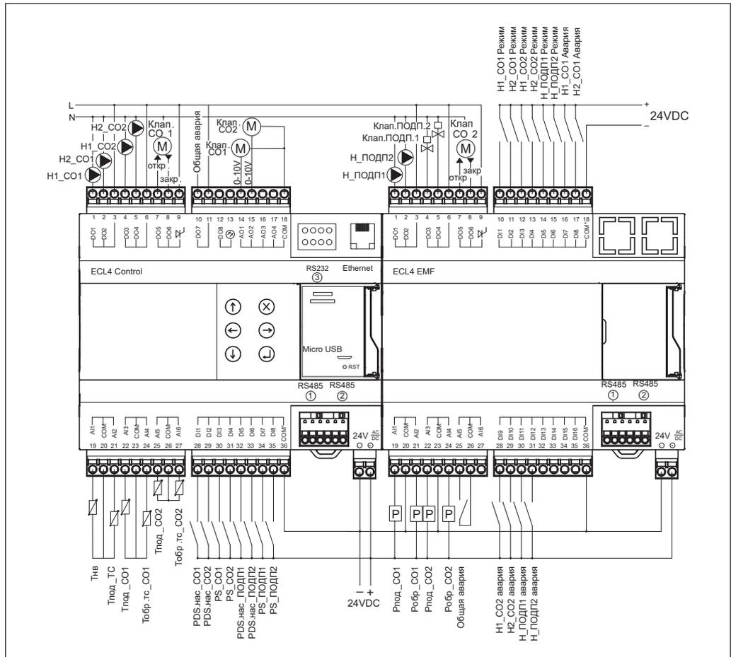
**Конфигурация входов и выходов контроллера ECL4 Control 361R Plus и ECL4 Control 361R Plus Ethernet**
