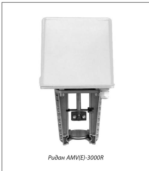
Электропривод предназначен для управления регулирующими клапанами VFM-2R DN100–200, VF-3R DN100–150, VFS-2R DN100–200 и VF-2R DN100–200. Управление приводом Ридан AMV-3000R осуществляется по импульсному сигналу от трехпозиционных электронных регуляторов Ридан ECL-3R/4R или подобных. Привод Ридан AME-3000R управляется аналоговым сигналом.
