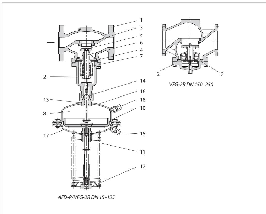
Если система находится в нерабочем состоянии, то клапан полностью открыт. Давление в системе после регулирующего клапана передается в полость под регулирующую диафрагму (со стороны настроечной пружины) через импульсную трубку. На другую сторону диафрагмы действует атмосферное давление.
