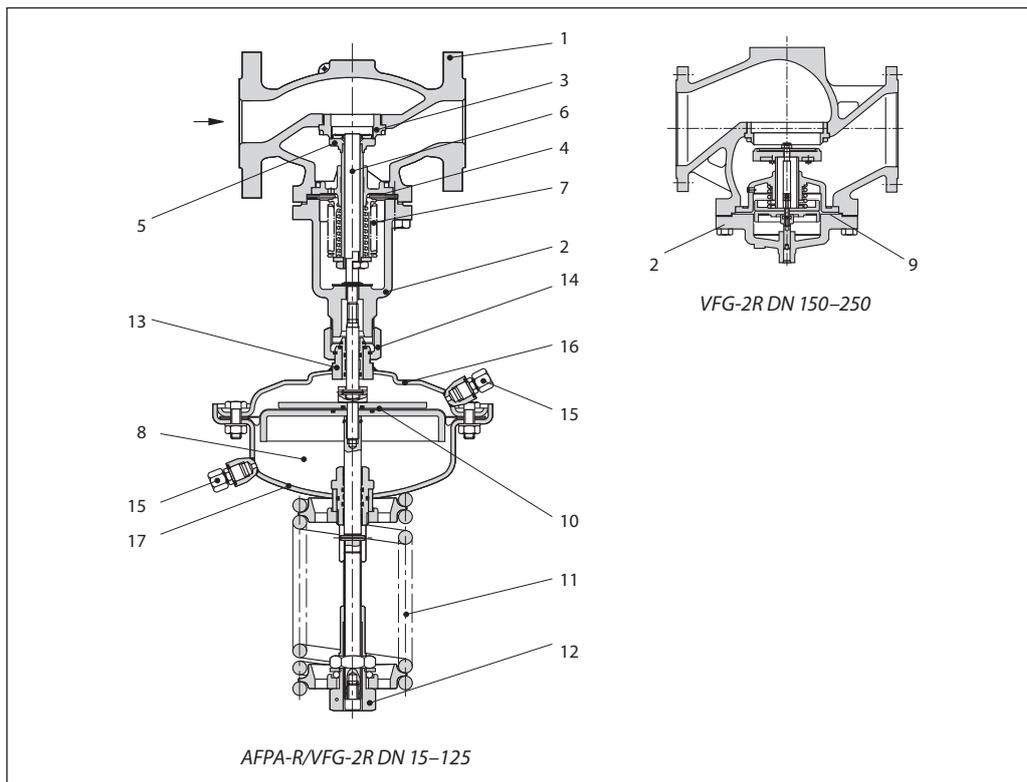
Давление в трубопроводе до и после регулятора передается в камеры над и под мембраной через импульсные трубки. При возрастании перепада давления свыше установленного значения клапан начинает открываться до тех пор, пока не установится равновесие между усилием
