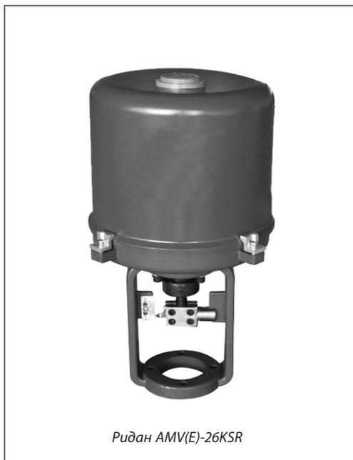
Электропривод предназначен для управления регулирующими клапанами VF-3R DN350–400. Управление приводом Ридан AMV-26KSR осуществляется по импульсному сигналу от трехпозиционных электронных регуляторов Ридан ECL-3R/4R или подобных. Привод Ридан AME-26KSR управляется аналоговым сигналом.
