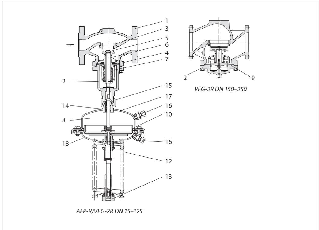
Рост давления в подающем и обратном трубопроводах будет передаваться через импульсные трубки в регулирующий блок. При возрастании перепада давления регулятор клапана
