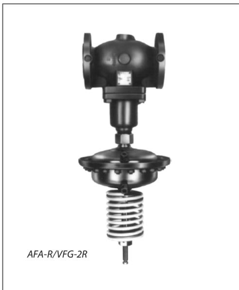
AFA-R/VFG-2R — автоматический регулятор Ридан, поддерживающий постоянное давление в трубопроводе до регулятора (по ходу движения теплоносителя). Предназначен для применения в системах централизованного теплоснабжения. При повышении давления до регулятора клапан открывается.
