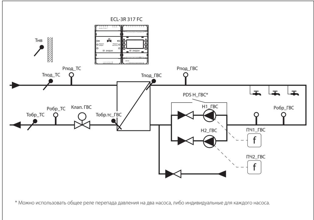
Схема электрических подключений ECL-3R 317 FC
