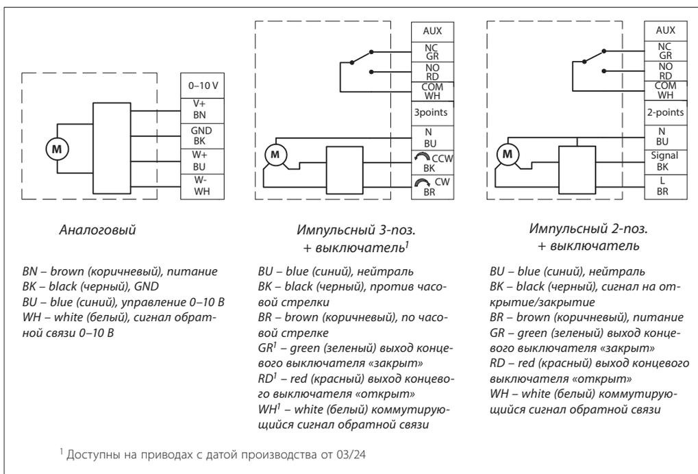
**Схема электрических соединений AMB-182R**
