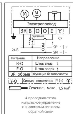
**Схема электрических соединений (продолжение)**
