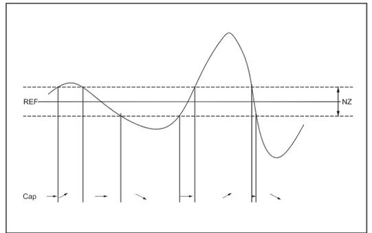
– Если давление выше величины «опорное значение + половина нейтральной зоны», разрешается включение следующего компрессора (стрелка вверх).
