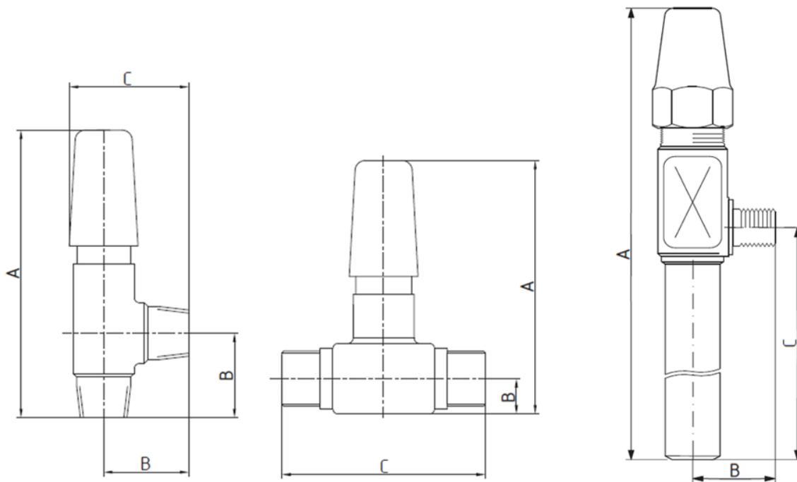
Рис. 2 – Основные размеры клапана
