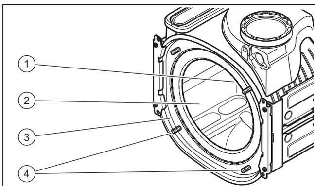
2. Четыре гайки резьбовых шпилек (4), ни в коем случае нельзя ослаблять или затягивать.
