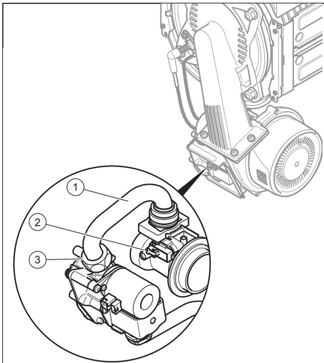
1. Снимите воздухозаборную трубу.
