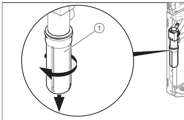
1. Снимите нижнюю часть сифона (1), повернув байонетный замок против часовой стрелки.
