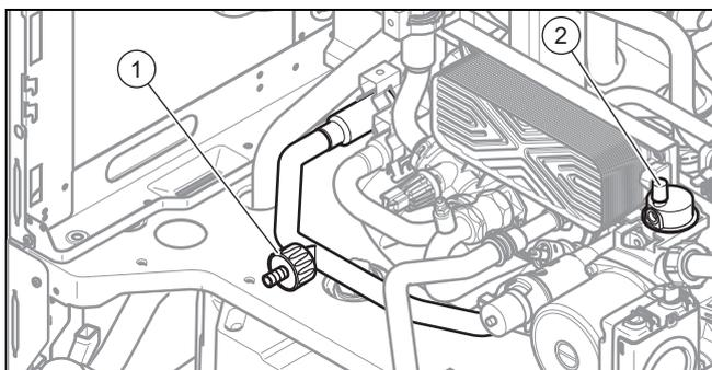
1. Перекройте сервисные краны на подающей линии системы отопления и обратной линии системы отопления.
