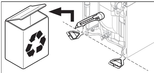
7. После установки изделия отрежьте захваты для транспортировки и утилизируйте их надлежащим образом.
