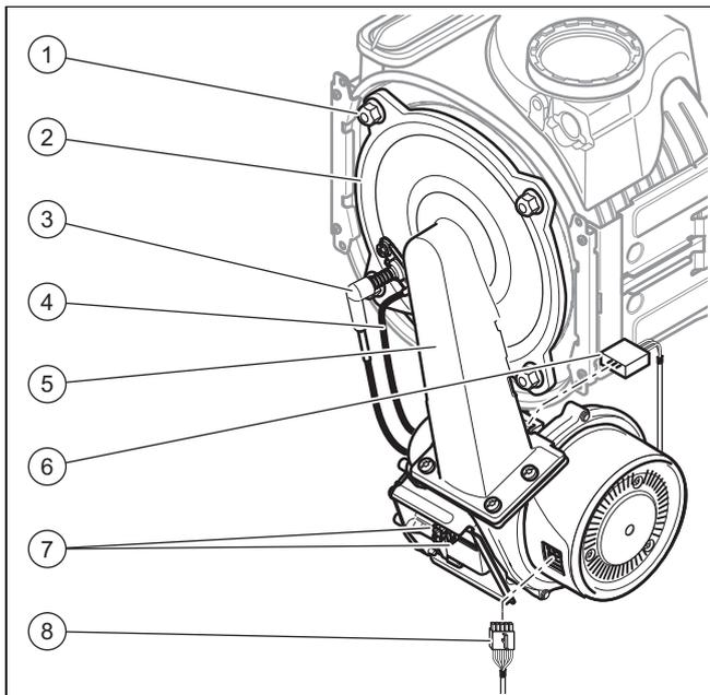
1. Установите компактный термомодуль (5), на теплообменнике.
