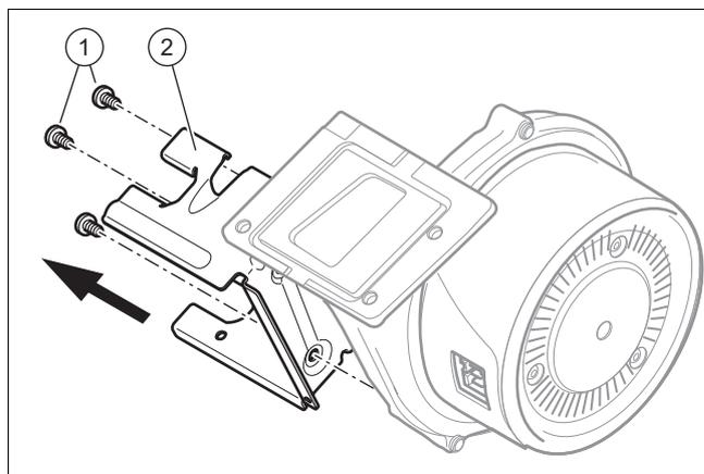
11. Демонтируйте крепление (2), газовой арматуры с вентилятора. Для этого открутите три винта (1)..
