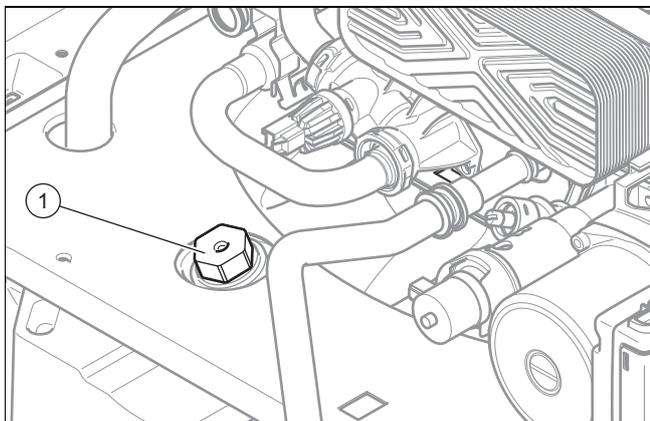
1. Опорожните контур технической воды прибора. (→ страница 33)
