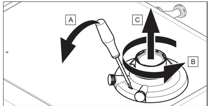
1. Вставьте отвертку в щель между измерительными шуцерами.
