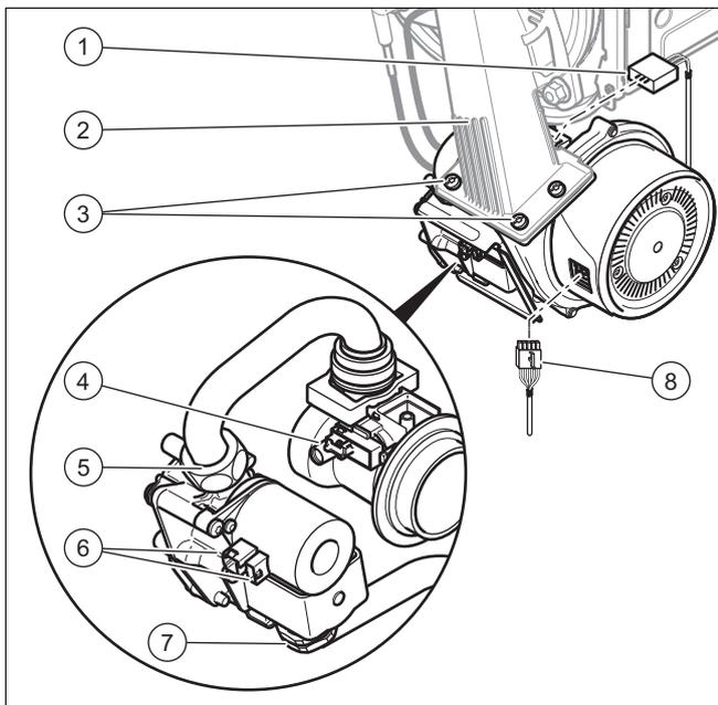
1. Снимите воздухозаборную трубу.
