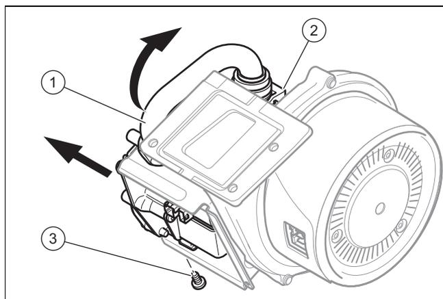
7. Снимите с прибора группу узлов, состоящую из вентилятора, сопла Вентури и газовой арматуры.
