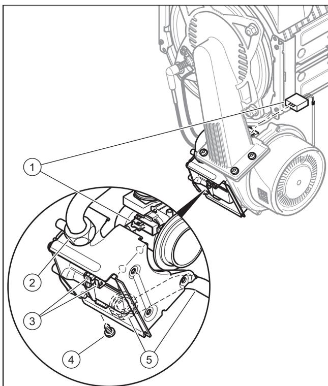
1. Снимите воздухозаборную трубу.
