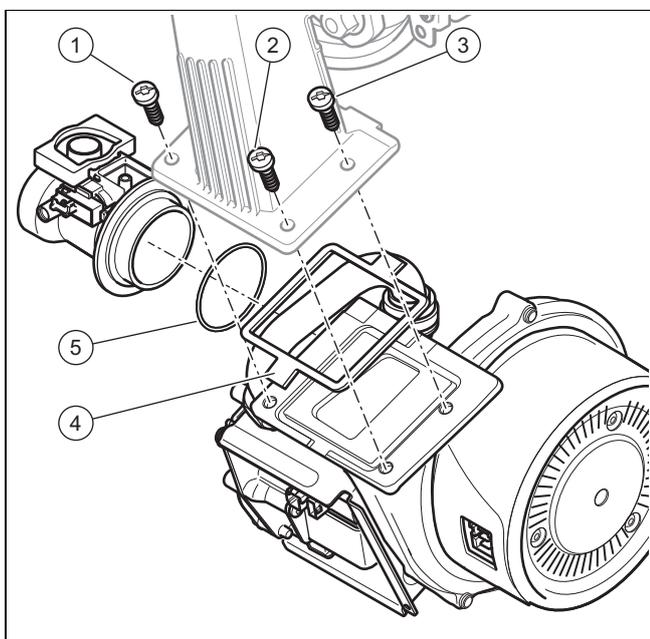
13. Установите детали на места в обратной последовательности. В местах (4) и (5) обязательно используйте новые уплотнения. Соблюдайте последовательность затяжки трех винтов, соединяющих вентилятор со смесительной трубой, следуя при этом нумерации (1), (2) и (3).
