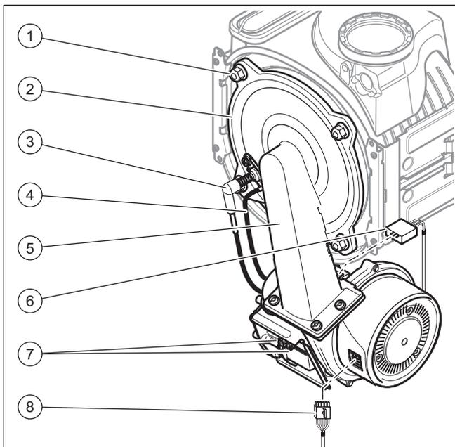
8. Отсоедините штекер кабеля розжига (3), и заземляющего кабеля (4), от электрода розжига.
