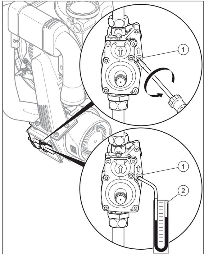
2. С помощью отвертки выкрутите уплотнительный винт из отверстия для измерительного прибора (1), (винт снизу) газовой арматуры.
