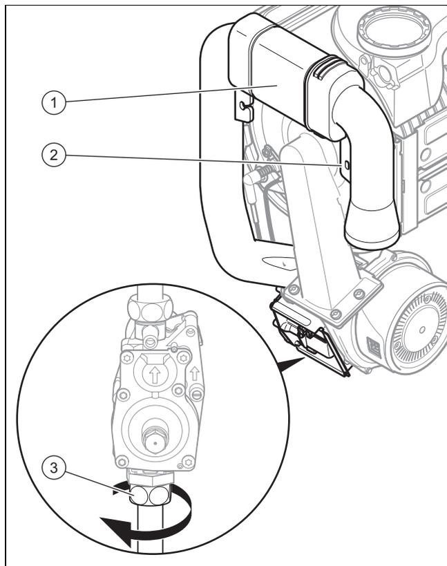
6. Открутите крепежный винт (2), и снимите воздухозаборную трубу (1), со всасывающего патрубка.
