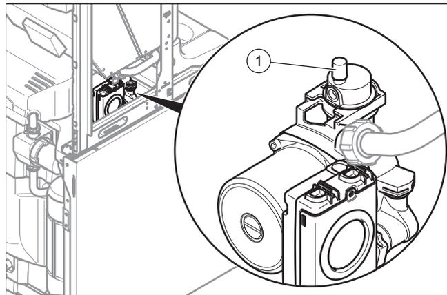
1. Ослабьте колпачок быстродействующего воздухоотводчика (1), на один два оборота и оставьте его в этом положении, поскольку во время эксплуатации из прибора таким образом автоматически удаляется воздух.
