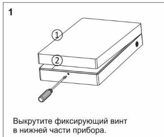
Выкрутите фиксирующий винт в нижней части прибора.
