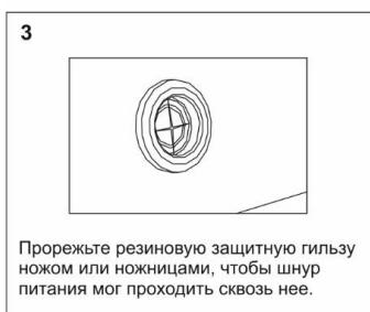
Прорежьте резиновую защитную гильзу ножом или ножницами, чтобы шнур питания мог проходить сквозь нее.
