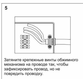
Затяните крепежные винты обжимного механизма на проводе так, чтобы зафиксировать провод, но не повредить проводку.
