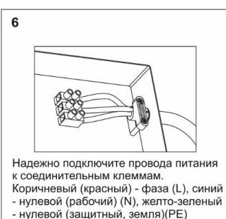
Надежно подключите провода питания к соединительным клеммам.
