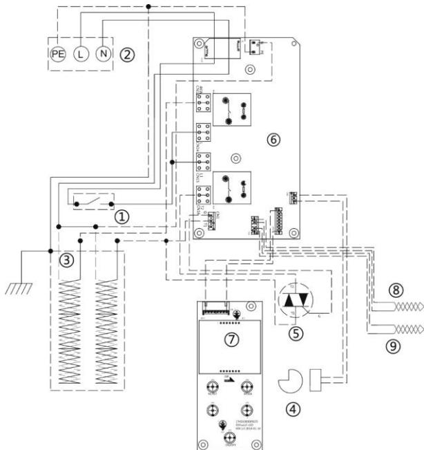
Рис.5 Электрическая схема ПЭВН
