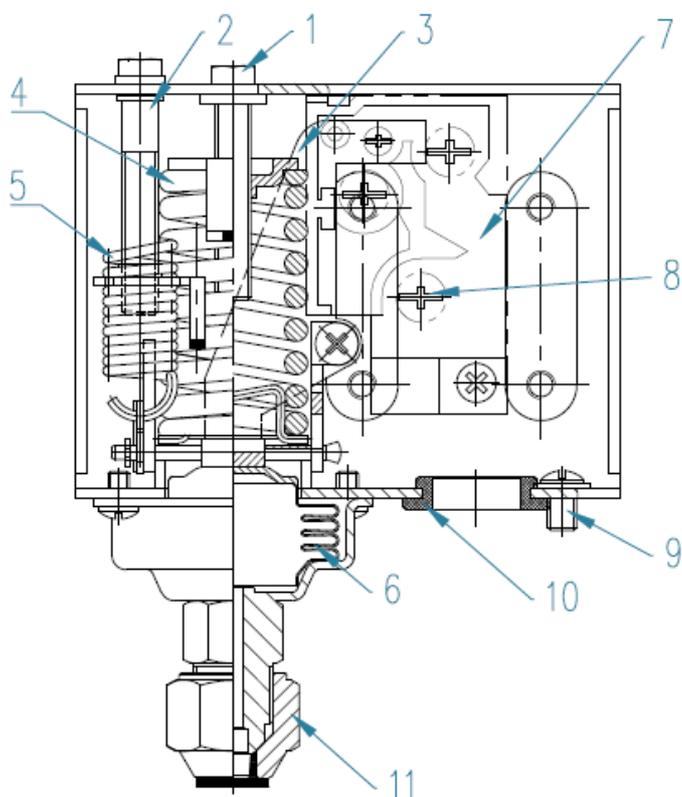
1. Регулировочный винт настройки давления
