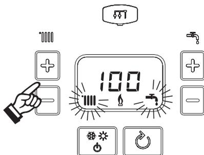
Рис. 29. Режим TEST (мощность системы отопления = 100%)
