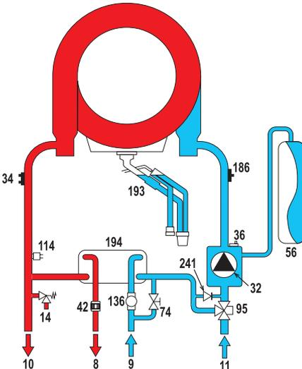
Рис. 41. Гидравлическая схема
