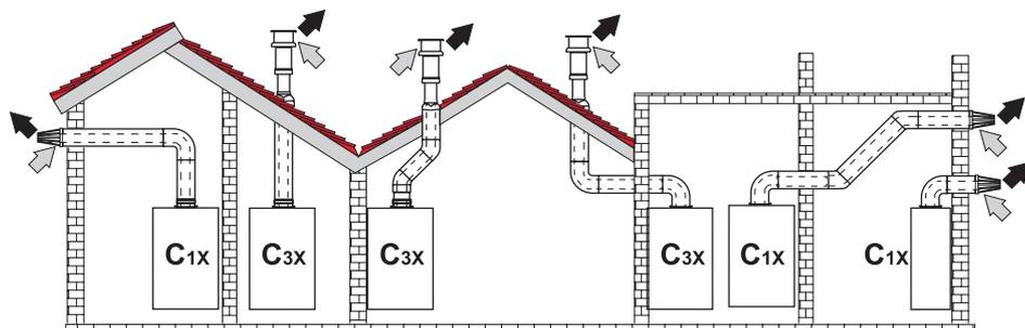
Рис. 20. Примеры присоединения с помощью коаксиальных труб
