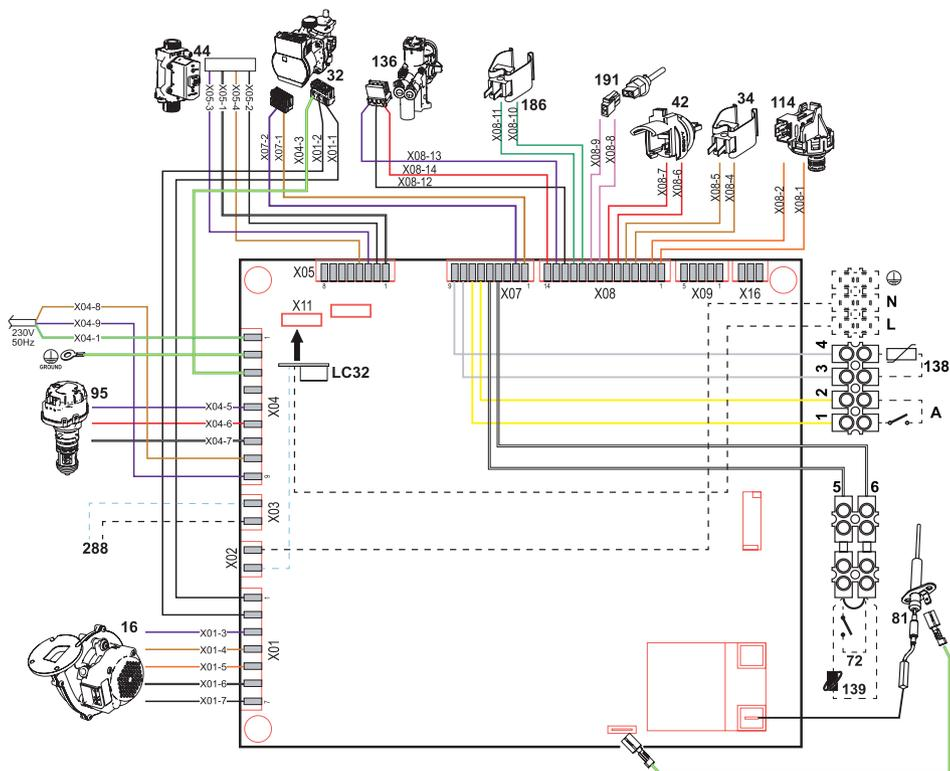
**Рис. 45. Электрическая схема**
