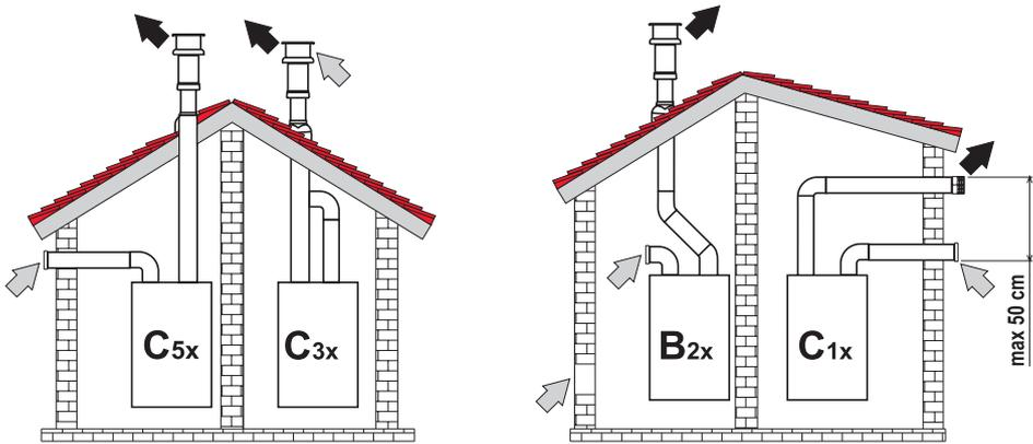
Рис. 22. Примеры присоединения с помощью отдельных труб
