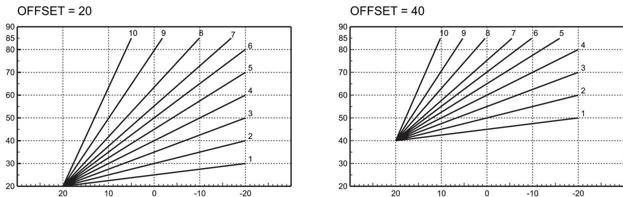
рис. 14 - Пример параллельного смещения компенсационных характеристик
