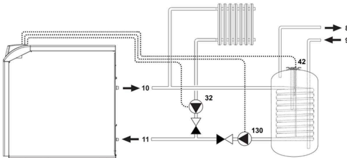
рис. 16 - Принципиальная схема соединения с внешним бойлером
