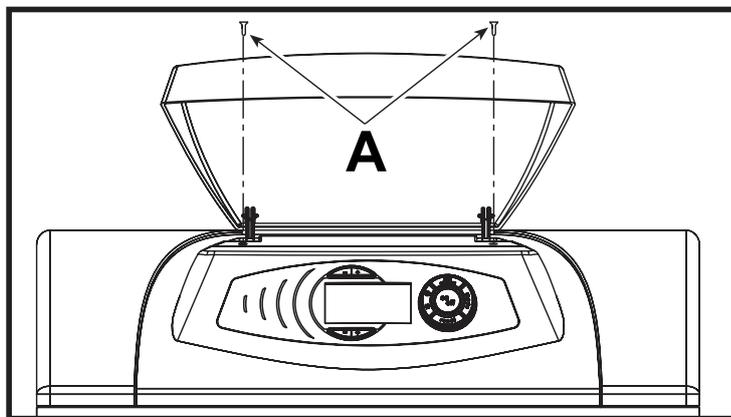
рис. 17 - Доступ к клеммной колодке котла
