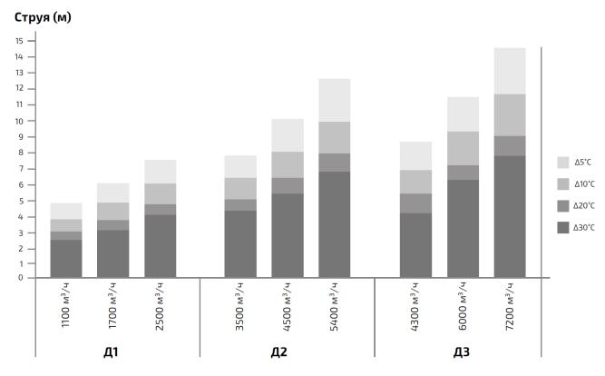
Длина струи изометрического воздуха при остаточной скорости 0,5 м/с.
