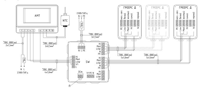
$<sup>^*</sup>$  К одному распределителю SW можно подключить до 20 аппаратов ГРЕЕРС Д1 или до 9 аппаратов ГРЕЕРС Д2 или до 6 аппаратов ГРЕЕРС Д3
