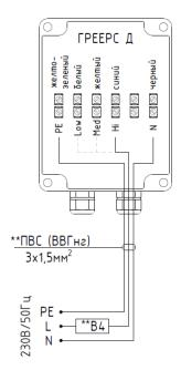
L-Hi – подключение (3 скорость); L-Med – подключение (2 скорость); L-Low – подключение (1 скорость); N – нейтраль; PE – заземление.
