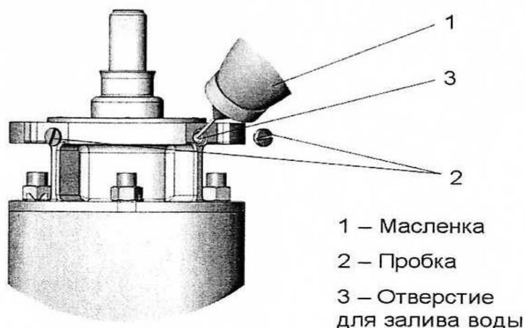
Непосредственно перед вводом в эксплуатацию необходимо выкрутить пробку и убедиться, что электродвигатель полностью заполнен водолицериновой смесью. Потерянную во время транспортировки жидкость следует дополнить пресной водой. Для этого необходимо выкрутить вторую пробку и с помощью масленки добавить воду до уровня заливных отверстий.
