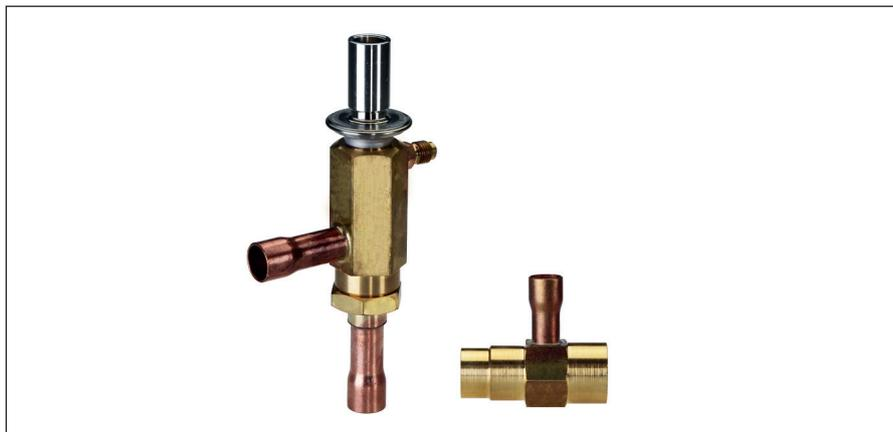
Регулятор производительности CPCE применяется для согласования производительности компрессора с фактической нагрузкой на испаритель.
