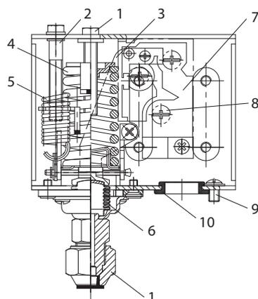
1. Регулировочный винт настройки давления
