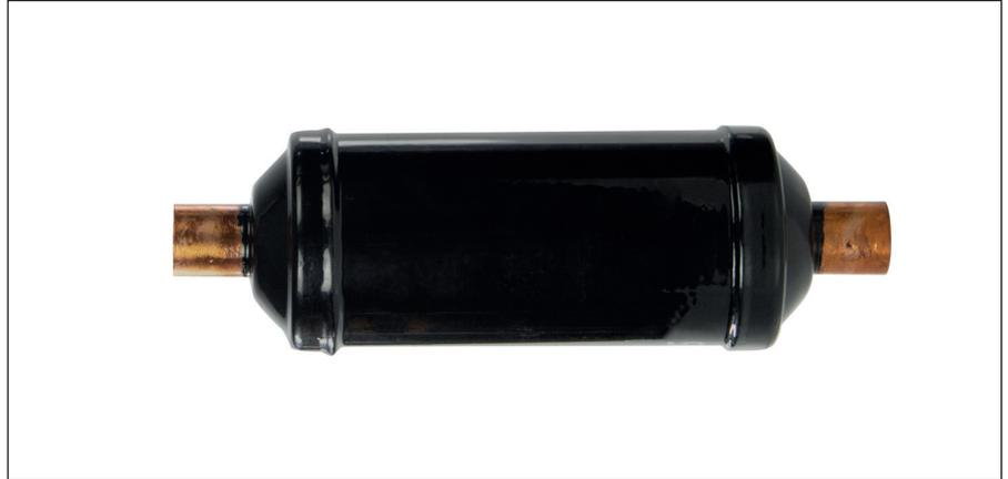
Фильтры-осушители для жидкостной линии типа DGL предназначены для защиты холодильных установок и систем кондиционирования от влаги и твердых частиц. Фильтры-осушители DGL оптимизированы для применения с ГФУ хладагентами и полиэфирными (POE) или полиалкилгликолевыми (PAG) маслами. Совместимы с ХФУ и ГХФУ хладагентами и минеральными или алкилбензолными маслами.
