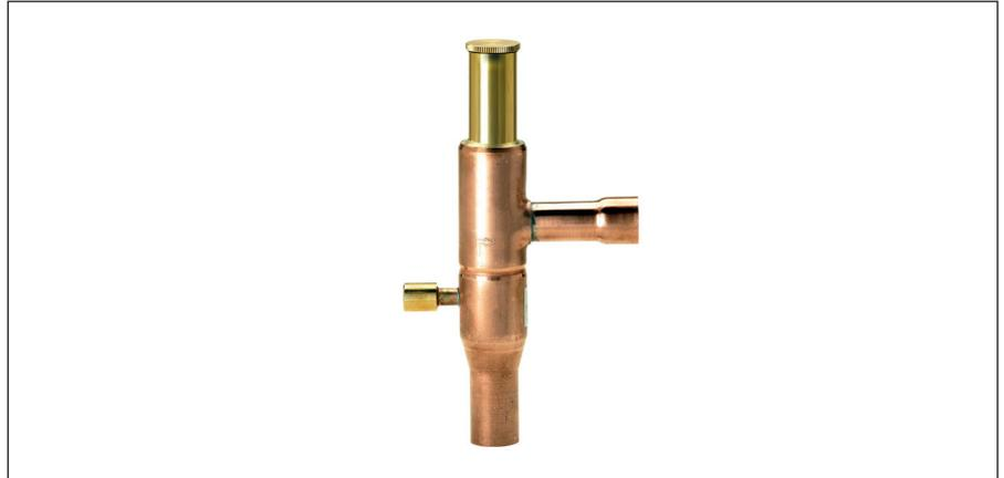
Регулятор давления кипения типа KVP устанавливается на линию всасывания после потребителя. Он поддерживает постоянное давление кипения, и, тем самым, постоянную температуру поверхности испарителя, защищает от слишком низкого давления кипения, а так же поддерживает разные давления в двух и более испарителях, установленных в системе с одним компрессором.
