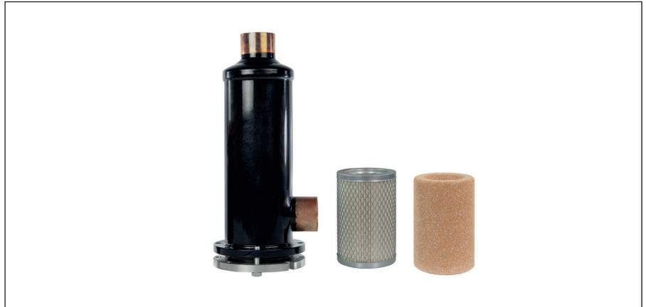
Фильтры DCR со сменным твердым сердечником (сердечниками) защищают холодильные установки и системы кондиционирования воздуха от влаги, кислот и твердых частиц.
