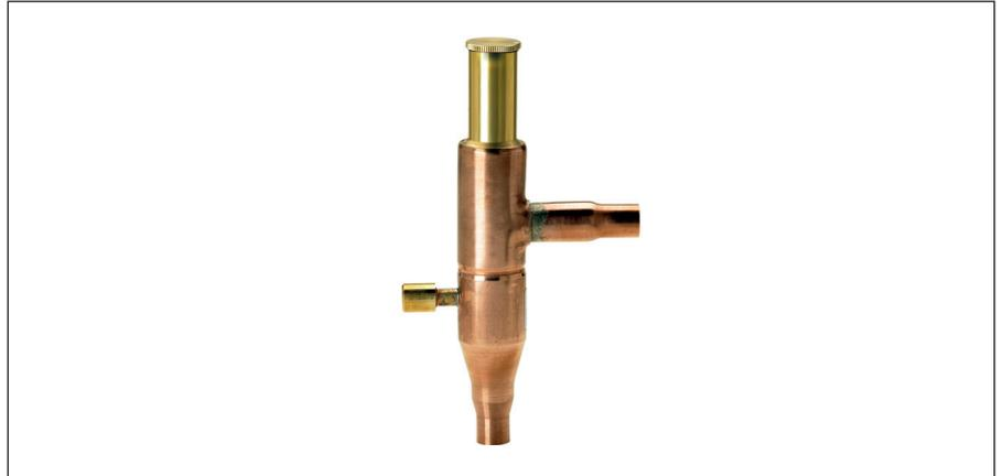
Регулятор давления в ресивере типа KVD устанавливается на линию перепуска с нагнетания в ресивер. Он открывается при снижении давления в ресивере и пропускает горячий газ с линии нагнетания для поддержания давления в ресивере на заданном уровне.
