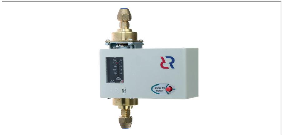
Реле перепада давления MP55 используется в качестве прибора автоматической защиты от снижения давления масла в картере компрессора. Если в течение определённого промежутка времени давление масла ниже заданного, то реле перепада давления отключит компрессор.
