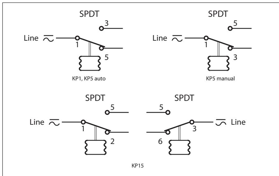
**Варианты подключения реле давления для различных применений**
