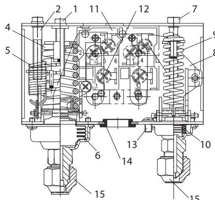
1. Регулировочный винт реле низкого давления (НД)
