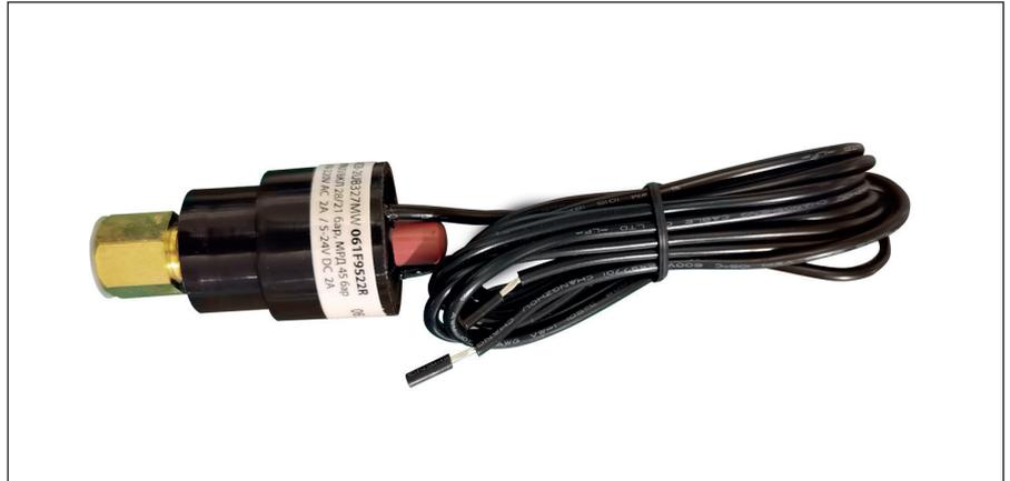
Картриджные реле давления типа АСВ представляют собой компактные реле давления с дисковой мембраной для использования в системах охлаждения и кондиционирования воздуха. Реле АСВ выпускаются в исполнении с автоматическим или ручным возвратом.
