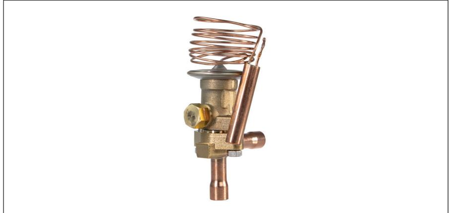
Терморегулирующие клапаны TE5-55 контролируют поступление жидкого хладагента в испарители. Расход хладагента регулируется по его перегреву на выходе из испарителя.
