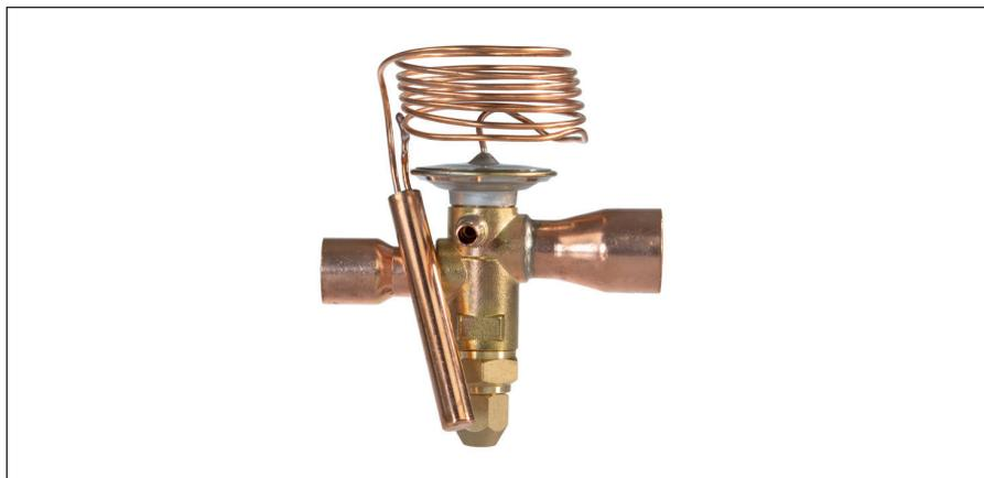
Терморегулирующие клапаны TGE контролируют поступление жидкого хладагента в испарители. Расход хладагента регулируется по его перегреву на выходе из испарителя.
