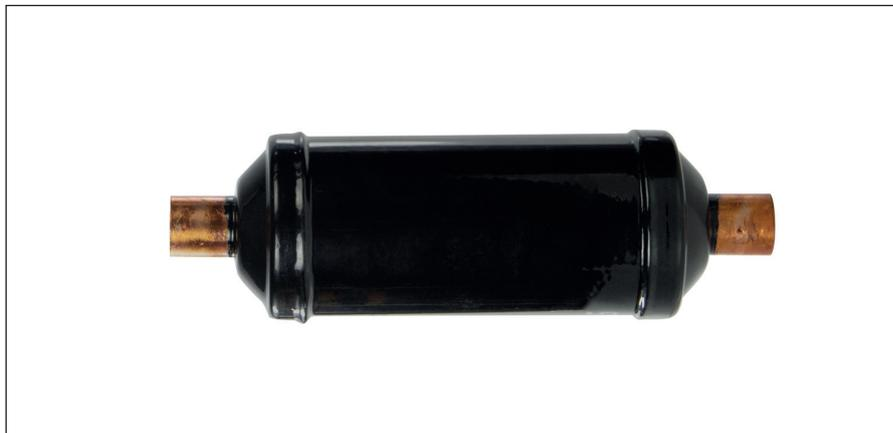
Фильтры-осушители для жидкостной линии типа DFL предназначены для защиты холодильных установок и систем кондиционирования от влаги и твердых частиц. Фильтры-осушители DFL оптимизированы для применения с ГХФУ и ХФУ хладагентами и минеральными или бензольными маслами. Совместимы с ГФУ хладагентами и полиэфирными (POE) или полиалкилгликолевыми (PAG) маслами.
