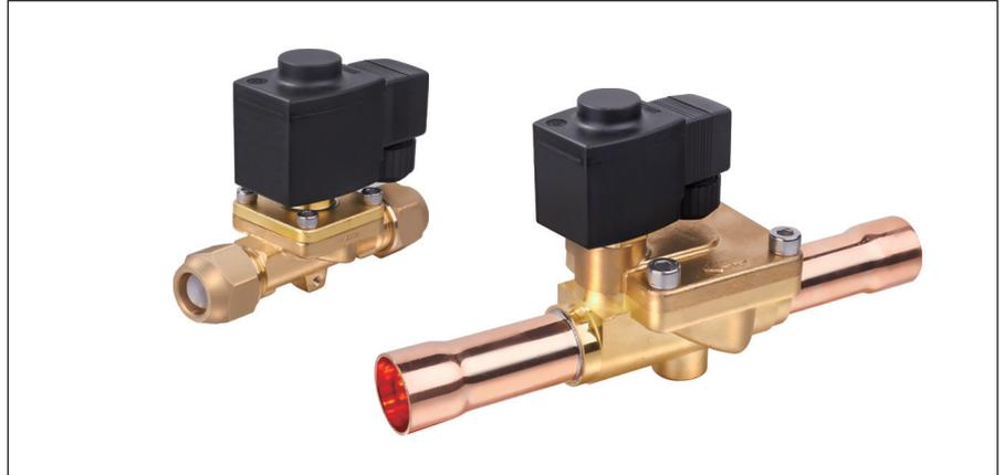
Электромагнитные клапаны **EVR** — это клапаны прямого или сервоприводного типа действия, предназначены для открытия или перекрытия потока хладагента на линиях жидкости, нагнетания, всасывания и горячего пара в холодильных установках при подачи на них управляющего сигнала.
