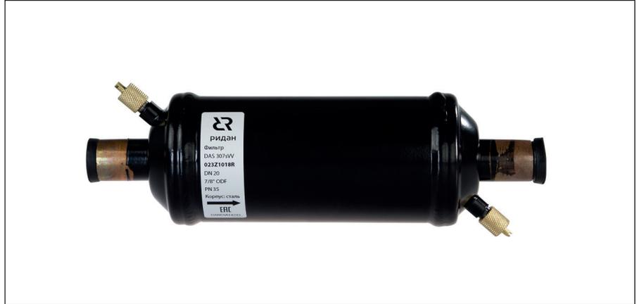
Антикислотные фильтры типа DAS используются во всасывающих линиях для очистки холодильных установок и систем кондиционирования воздуха с фторсодержащими хладагентами от продуктов сгорания обмоток электродвигателя компрессора.
