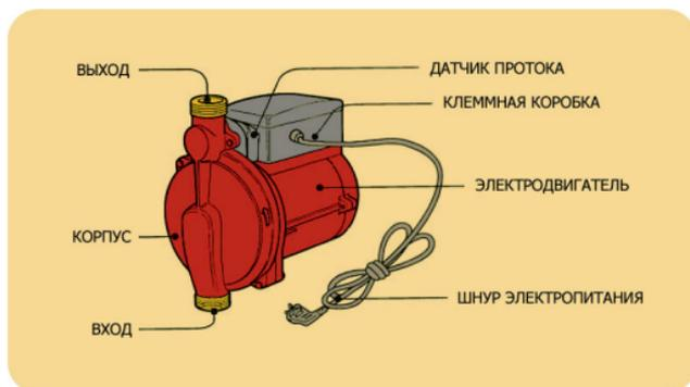
Насосы с «мокрым» ротором серии UPA предназначены для небольшого повышения давления в существующей системе водоснабжения частных домов. Они используются для создания напора в одной точке водоразбора, например, перед водонагревателями, газовыми колонками, стиральными и посудомоечными машинами, при перекосе давления холодной/горячей воды в смесителе и т.д.
