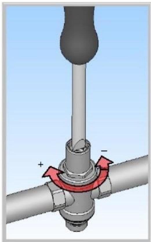
Перед монтажом откройте все краны для промывки системы, и удаления лишнего воздуха из труб. Рекомендуется установка дополнительных перекрывающих кранов на входе и выходе для облегчения возможного ремонта в будущем.
