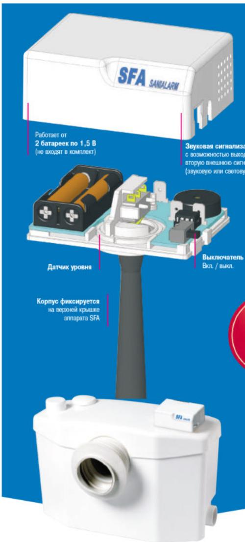
**SANIALARM®** — фиксируется на крышке насоса SFA. Состоит из датчика уровня, который автоматически включает звуковой сигнал, когда уровень воды в насосе превышает максимально допустимый. Звуковой сигнал может быть выключен вручную тумблером на корпусе либо автоматически при снижении уровня воды в насосе до допустимого уровня.
