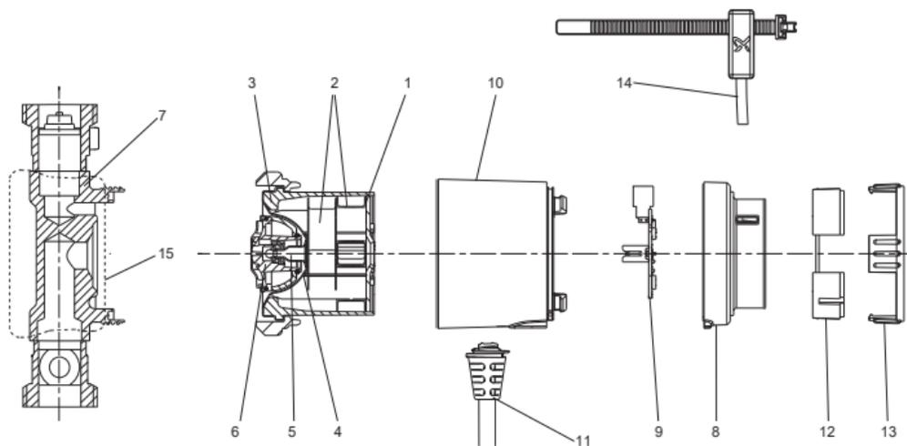
Рис. 1 Разрез насоса типа COMFORT
