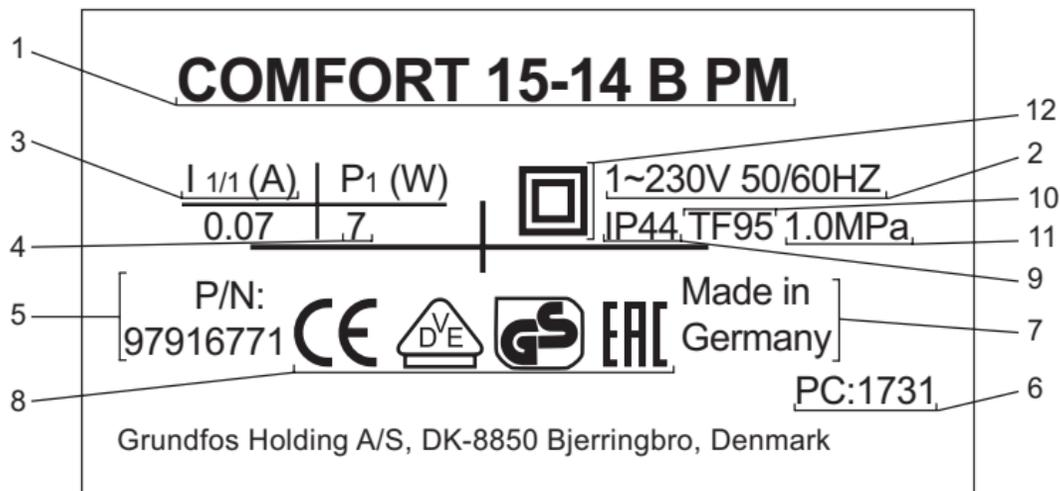
Рис. 2 Фирменная табличка циркуляционных насосов типов COMFORT
