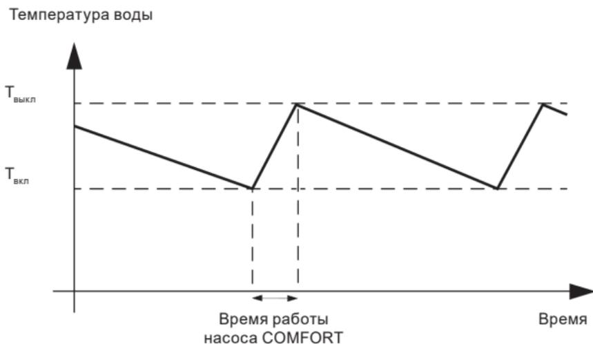
**Рис. 3** Иллюстрация работы режима контроля температуры
