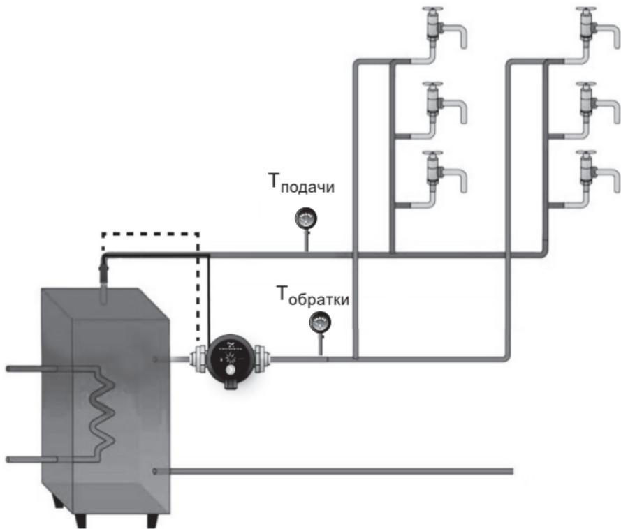
Рис. 4 Насос COMFORT с двумя датчиками температуры в системе ГВС
