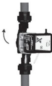
5. Установите насос в нужное положение и зафиксируйте HEX винтами
