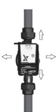
1. Предварительно определите направления установки
