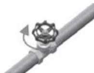
3. Слейте теплоноситель из системы и перекройте запорную задвижку
