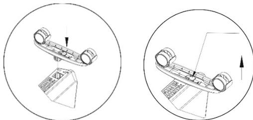
**Рис. 1** Установка/снятие шасси
